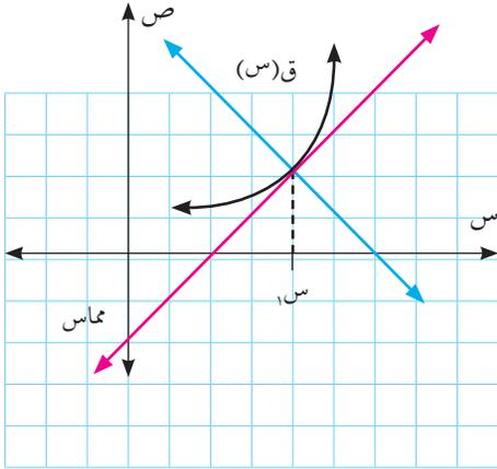
نلاحظ في الشكل المجاور أن معدل التغير للاقتران ق(س) (ميل المنحنى) عند  $s_1$  هو ميل المماس المرسوم للمنحنى وتساوي ق'(س<sub>١</sub>) ونسمي النقطة (س<sub>١</sub>، ق(س<sub>١</sub>)) نقطة التماس.
