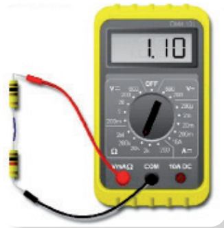
الشكل (٤) قياس المقاومة بجهاز المالتيميتر
