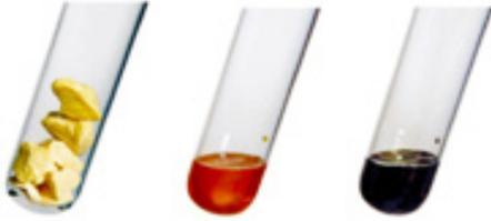
4- ضَعْ كَمِّيَّة من الكبريت في أنبوب اختبار، وأمسك الأنبوب باستخدام ملقط خشبي، وقُمْ بتسخينها باستخدام لهب بنسن، وسجِّل سلسلة التغيُّرات التي يمرُّ بها الكبريت أثناء تسخينه من حيثُ اللون، واللزوجة.
