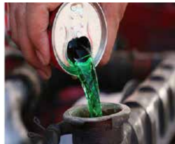
إضافة مادة مانعة للتجمد إلى الماء في مبرد (راديتور) سيارة
