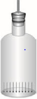
س٨: في الشكل المجاور وعاء زجاجي مملوء بالماء تؤثر قوة مقدارها ١٢ نيوتن في سداده التي مساحتها ٦ سم<sup>٢</sup>، فإذا علمت أن مساحة قاعدته ٦٠٠ سم<sup>٢</sup>.
