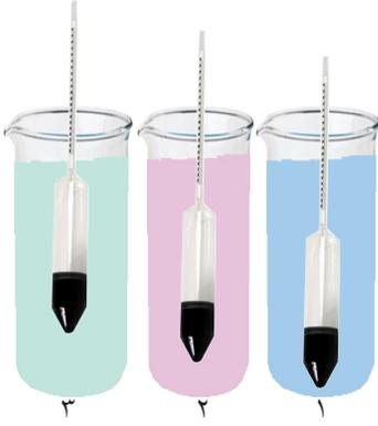
الشكل المجاور يبين جهاز الهيدروميتر وهو مغمور في سوائل مختلفة، حسب ذلك الشكل أيّ السوائل أكبر كثافة وأيهما أقل كثافة؟
