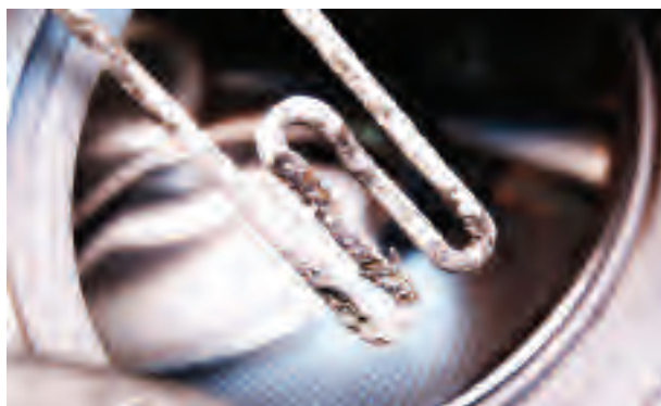
الشكل (8): ظاهرة التكلُّس
