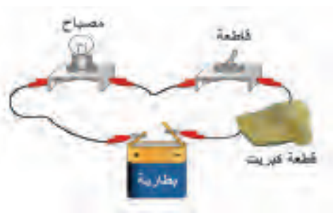
الشكل (4): توصيل قطعة كبريت بالدائرة الكهربائية
