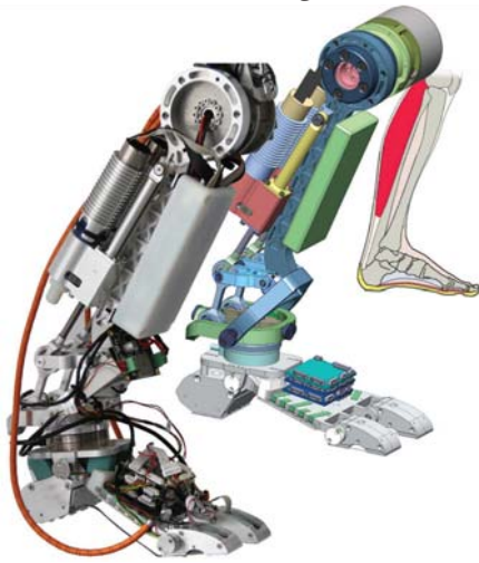
ساق الرجل الآلي مدعومة بالعضلات الهوائية
