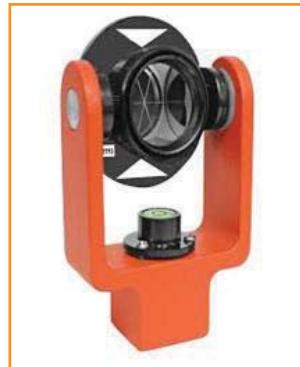
تستخدم هذه الأجهزة لقياس المسافات الطويلة بدقة عالية، وقد تعمل بصفة مستقلة أو تركب على جهاز الشيودولait لقياس المسافات والزوايا معاً. وتعمل هذه الأجهزة بالأشعة ويطلق عليها الدستومات (distomat)، ويعتمد مبدأ عملها على وضع الجهاز على طرف المسافة المراد قياسها والعاكس (Reflector) على الطرف الآخر، حيث يرسل الجهاز بإرسال الأشعة إلى العاكس الذي يعيد بثها إلى الجهاز، وبمعرفة سرعة الأشعة وזמן إرسالها واستقبالها يقوم الجهاز بحساب المسافة (D).
