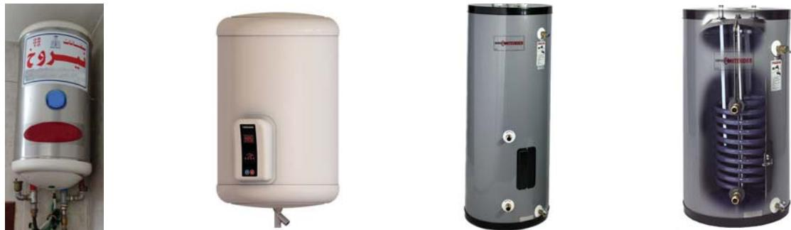
وهي تتوافر بأشكال مختلفة تصنع من الفولاذ الذي لا يصدأ (ستانلس ستيل)، وقد تطلّى من الداخل بالسيراميك، وتعتمد هذه الأجهزة في تسخين المياه على مقاومة كهربائية تنقل الحرارة إلى الماء المتجمّع داخل خزان معدنيٍّ معزول حرارياً. وتكون هذه المقاومة مزودة بمنظم درجة حرارة يفصل الطاقة الكهربائية عن عنصر التسخين في حال وصلت درجة الماء إلى الدرجة المعيّنة عليها.
