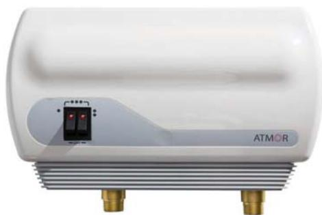
تحتوي هذه السخانات على أسطوانة من البلاستيك المقوّى بداخلها عنصر تسخين (مقاومة كهربائية) بقدرة كهربائية تراوح ما بين (3 - 7 كيلو واط في الساعة)، يدخل الماء من فتحة دخول الماء البارد ليضغط على مفتاح تدفق كهربائي يوصل التيار الكهربائي إلى مفاتيح التشغيل ومنها إلى المقاومة الكهربائية، حيث يسخن الماء داخل الأسطوانة ليخرج عبر فتحة خروج الماء الساخن.
