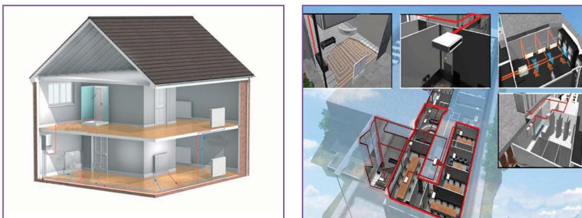
تستخدم التدفئة المركزية لتدفئة المنازل والمنشآت العامة، ويتم ذلك عن طريق تمرير وسيط تسخين (ماء، هواء ساخن، بخار، غاز) من خلال مشعات حرارية تنقل الحرارة إلى الحيز
