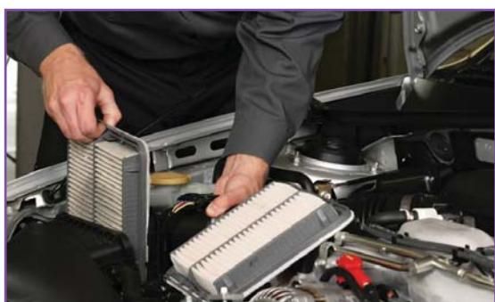
يجب تغيير فلاتر الهواء والوقود حسب نتيجة فحصها في كل مرة تزور فيها المركبة مركز الصيانة، بشكل عام يجب تغيير فلاتر الهواء والزيت والوقود كل 20000 - 25000 كلم.
