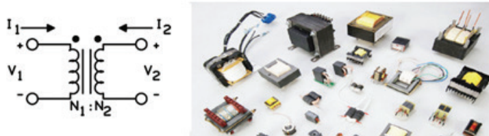
شكل (49) المحول الكهربائي ورمزه
