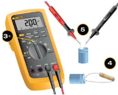
شكل (34) طريقة قياس المواسع من خلال جهاز DMM وشكل جهاز LCR Meter
