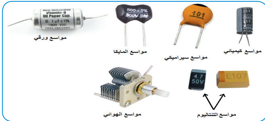
شكل (3): أصناف المواسعات تبعاً للمادة المستخدمة في العزل
