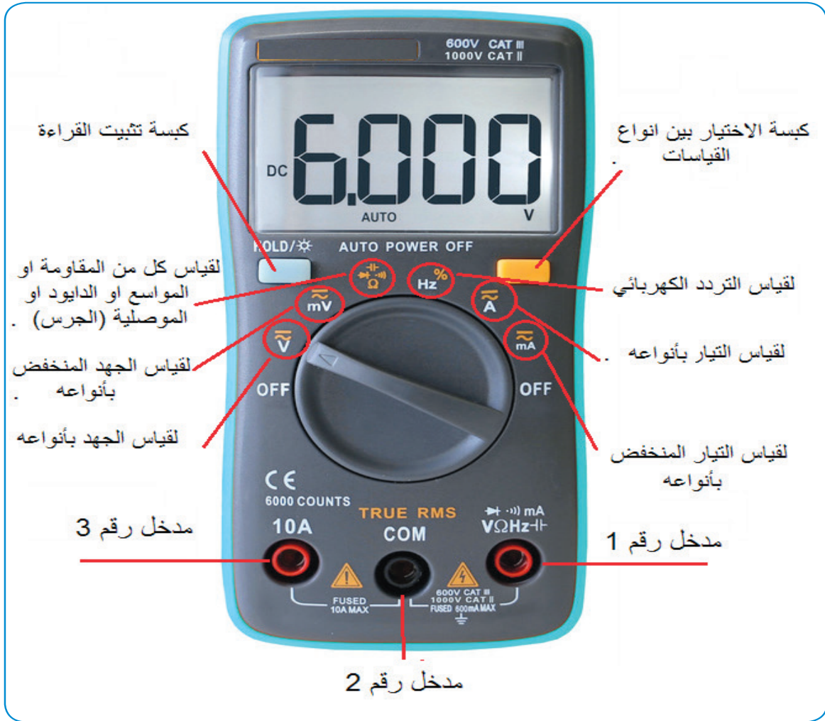
شكل (4): صورة تفصيلية لجهاز قياس رقمي ذي مدى مفتوح
