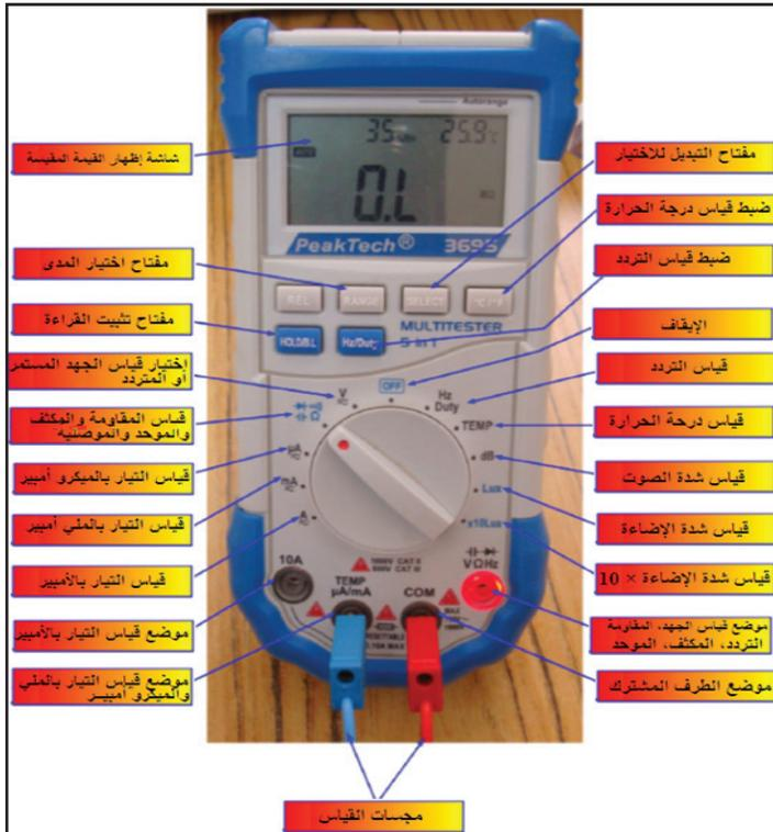
يُقاس التيار بجهاز الأميتر، وتقاس الفولتية بجهاز الفولتميتر، ويوصل جهاز الأميتر على التوالي مع الحمل المراد قياس تياره، أما جهاز الفولتميتر فيوصل على التوازي مع طرفي الحمل المراد قياس فولتيته، بحيث يوصل قطبه الموجب بالقطب الموجب للفولتية، وقطبه السالب بالقطب السالب لتلك الفولتية.
