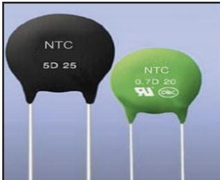
1. التيرميستورات ذات المعامل الحراري السالب (NTC): ترتفع حرارتها عند مرور التيار الكهربائي بها، وتبدأ قيمة المقاومة بالانخفاض تدريجياً، ويوجد منها لونان: أسود، وأخضر، وقياسها ثابت، وتستخدم في مجسات الحرارة في السيارة.
