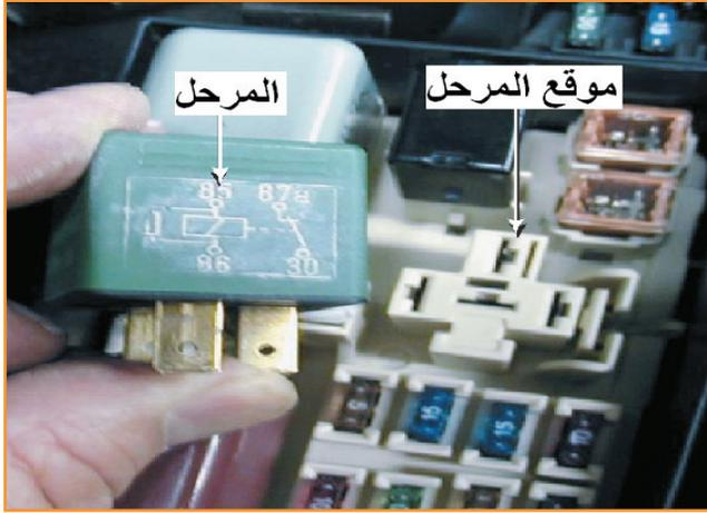
وهو عبارة عن مفتاح تبديل كهرومغناطيسي يستخدم في العديد من الدارات الكهربائية للسيارة بتصاميم ومواصفات مختلفة وفقا لطبيعة استخدامها، وقد استخدمت المرحلات في دارات الإنارة ودارات رفع الزجاج الكهربائي ومساحات الزجاج ودارة بدء الحركة وغيرها العديد من الدارات الكهربائية في السيارة، وعادة ما تكون المرحلات موجودة مع المصهرات في نفس العلبة كما هو مبين بالشكل أو تكون بعلبة خاصة بالمرحلات.
