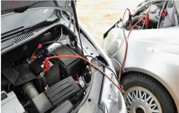
1. الشحن عن طريق سيارة أخرى تعمل بشكل سليم: يُمكن الشحن عن طريق سيارة أخرى، بأن تمتلك كوابل للتوصيل بين أقطاب البطارية التي داخل السيارة التي تحتاج إلى الشحن، وبين أقطاب البطارية التي داخل السيارة التي سأشحن عن طريقها، ونُشغل السيارة التي أوّد الشحن من خلالها؛ كي يعمل المولد بشكل سليم، ويكون لديه القدرة على شحن البطارية الفارغة بشكل جيد.
