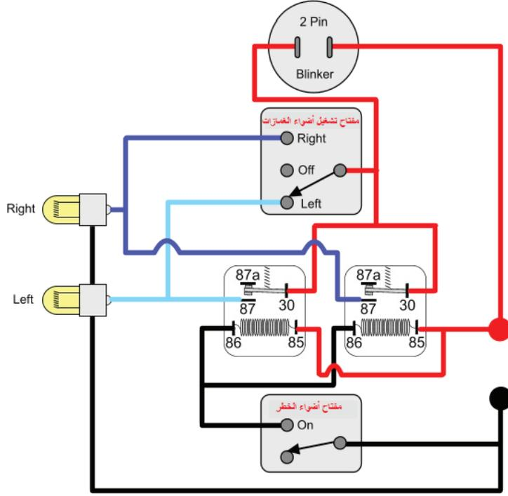
الشكل (1): الدارة الكهربائية لأضواء الانعطاف
