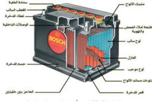
تتولد الكهرباء من البطارية الحمضية عن طريق التفاعل الكيميائي بين الرصاص وحمض الكبريت المخفف، فعندما يحدث هذه التفاعلات يتم تأيين الألواح مما يؤدي إلى حركة مستمرة للأيونات السالبة والموجبة فتولد القوة الدافعة الكهربائية .
