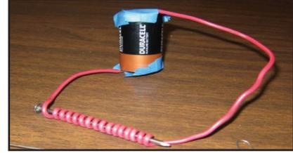
الشكل (16): صناعة المغناطيس الكهربائي
