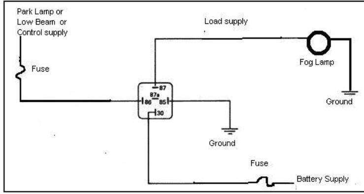
الشكل (1): الدارة الكهربائية لأضواء الضباب
