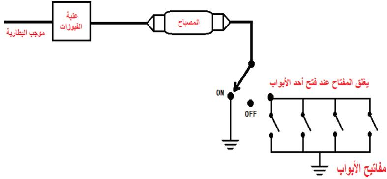
الشكل (1): الدارة الكهربائية لغرفة السائق
