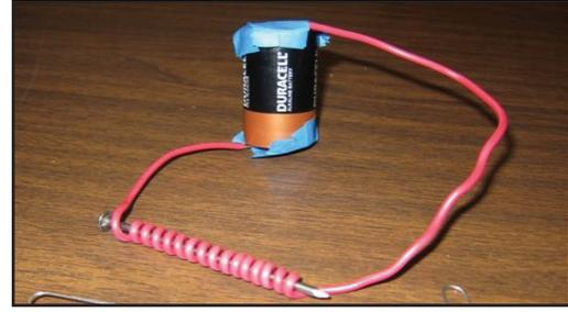
الشكل (18): المغناطيس الكهربائي
