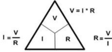
**وصف الموقف التعليمي:** قام أحد الزبائن ببناء دائرة كهربائية بسيطة، وعند قيامه بقياس التيار المارّ بالمصباح، قام بتغيير فرق جهد المصدر، وعند كل مرة يقوم بقياس التيار، فيلاحظ تغييراً في قيمته، ولكنه لاحظ أنّ النسبة بين الجهد والتيار تبقى دائماً ثابتة، فطلب منّا تحليلاً لهذه الظاهرة.
