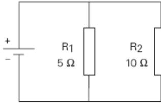
بتطبيق القانون الأصلي، سأجد أنّ النتيجة هي:  $R_t = \frac{R_1 \times R_2}{R_1 + R_2}$
