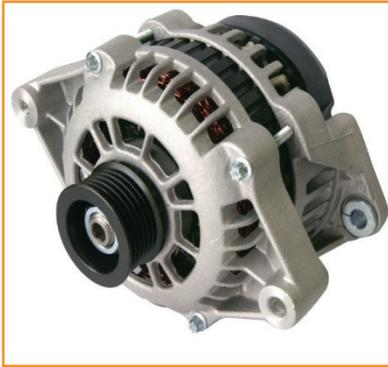
المولّد المستخدم في منظومة التوليد والشحن في السيارة مولّد تيار متناوب ثلاثي الأطوار، حيث يتمّ توحيد التيار، وتحويله إلى تيار مستمر، باستخدام مجموعة التوحيد (الديودات)، ويستمد المولّد حركته من عمود المرفق، وتعتمد الفولتية المتولدة على سرعة دورانه التي تعتمد على سرعة المحرّك، لذلك لا بدّ من وجود منظومة تعمل على تنظيم الفولت الناتج من المولّد، ليبقى ضمن مدى ثابت (13 - 15) فولت، والذي يقوم بهذه العملية منظمّ الجهد.
