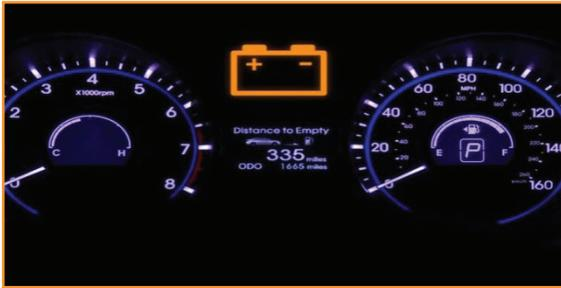
تُرَوّد لوحة البيان والتحذير (الساعات) في السيارات بضوء إشارة خاص؛ للدلالة على عمل نظام التوليد والشحن، وهذه الإشارة عبارة عن شكل بطارية تضيء عند إغلاق الدارة الكهربائية بوساطة مفتاح التشغيل (السويتش)، وتنطفئ مباشرة عند دوران محرّك السيارة، وفي حالة إضاءتها، ومحرّك السيارة يعمل، تدلّ على وجود خلل في نظام التوليد والشحن.
