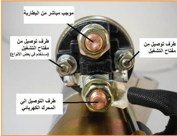
الشكل (2): توصيل المفتاح الكهرومغناطيسي بالبطارية
