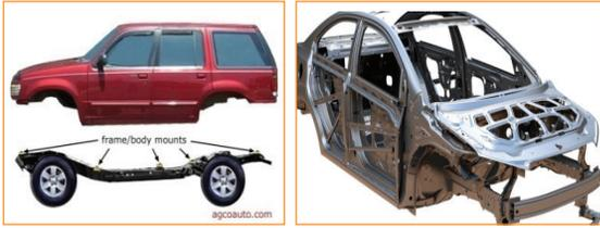
يُعدّ الهيكل العمود الفقري للمركبة، وتُرَكَّب عليه مكونات المركبة وأجزاؤها. ويُعدّ جسم المركبة الجزء المخصص لنقل الركاب والبضائع، وغرفة القيادة. وفي بعض المركبات، يمكن فصل جسم المركبة عن الهيكل.
