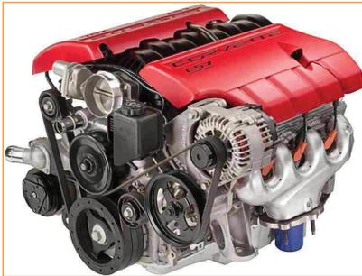
يقوم المحرّك بتوليد القدرة اللازمة لتحريك السيارة، عن طريق تحويل الطاقة الكيميائية للوقود إلى طاقة حرارية ناتجة عن حرق الوقود في داخله، ولذلك سُمّي محرّك الاحتراق الداخلي، ثمّ إلى طاقة ميكانيكية. يحتوي المحرّك على أنظمة متعددة؛ لتمكينه من القيام بعمله.
