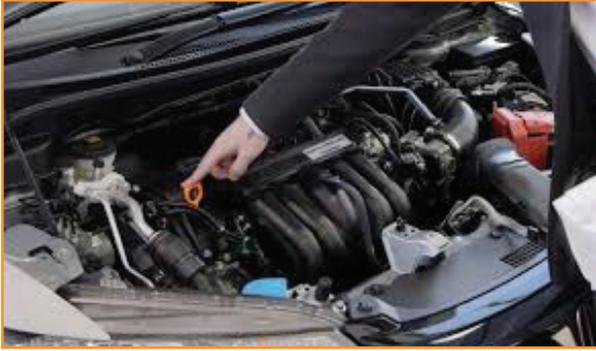
الشكل (7): موقع مقياس (عيار) الزيت
