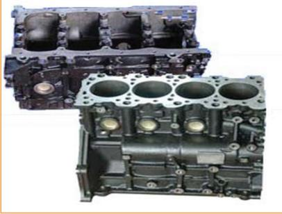
4. **جسم المحرك:** يُصنع من سبيكة الألمنيوم أو الحديد الزهر الرمادي، ويتكون من الأسطوانات، وكراسي التحميل الثابتة، ومجاري سائل التبريد، والزيت، ويُركّب عليها رأس المحرك، وأجزاء أخرى.
