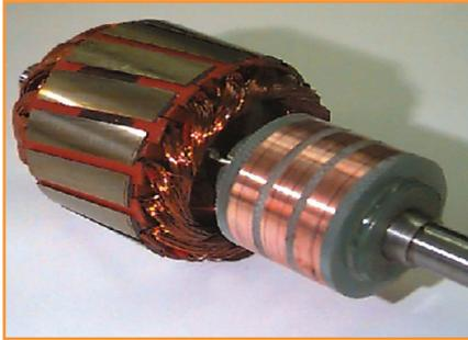
يُصمّم العضو الدوّار في مولّدات التيار المتناوب بعدّة طرق، أكثرها شيوعاً العضو الدوّار ذو القطب المشطور، ويتألّف من ملف من النحاس الملفوف حول قلب معدني من الحديد، وعند مرور تيار كهربائي في ملفات العضو الدوّار يتولد حول قلب العضو الدوّار مجال مغناطيسي.
