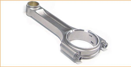
3. **ذراع التوصيل:** يُصنع من سبائك الفولاذ المطروق، ووظيفته نقل القوة من المكبس إلى عمود المرفق، وبهذا يحوّل الحركة الترددية للمكبس إلى حركة دائرية لعمود المرفق.
