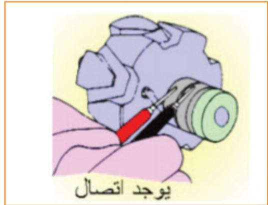
الشكل (1): فحص العضو الدوّار بواسطة جهاز قياس المقاومة (الأومميتر)؛ للتأكد من الاتصال بين الحلقات
