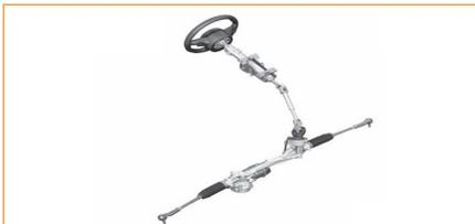
تُعدّ الوظيفة الأساسية لنظام التوجيه في السيارات هي توجيه السيارة للاتجاه، أو المسار المناسب، وذلك بتمكين السائق من توجيه العجلات الأمامية إلى أي جانب يرغب؛ حتى نصل إلى قيادة سهلة وآمنة.
