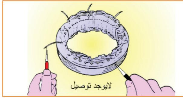
الشكل (5): فحص العضو الثابت بواسطة جهاز المقاومة (الأومميتر)؛ للتأكد من عدم وجود اتصال أرضي بين الملفات وجسم العضو الثابت
