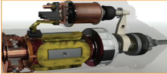
بادئ الحركة في السيارة: هو عبارة عن محرك كهربائي صغير، نستطيع بوساطته تدوير المحرك؛ لبدء الحركة عند أول تشغيل، ويتم تشغيل بادئ الحركة عن طريق البطارية، حيث تقوم بوصل التيار اللازم لتدوير المحرك حتى يبدأ بالحركة. وكغيره من القطع الأخرى الموجودة في السيارة، يتعرّض للتلف، ولمجموعة من الأعطال تكون فيه، أو بوساطة القطع المرتبطة معه، وسأحاول أن أتطرق إلى أهمها في هذا الموضوع، وهي كالاتي:
