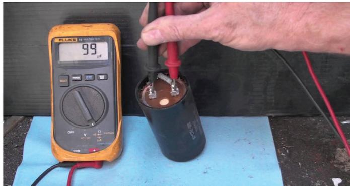
الشكل (12): قياس المواسع باستخدام DMM
