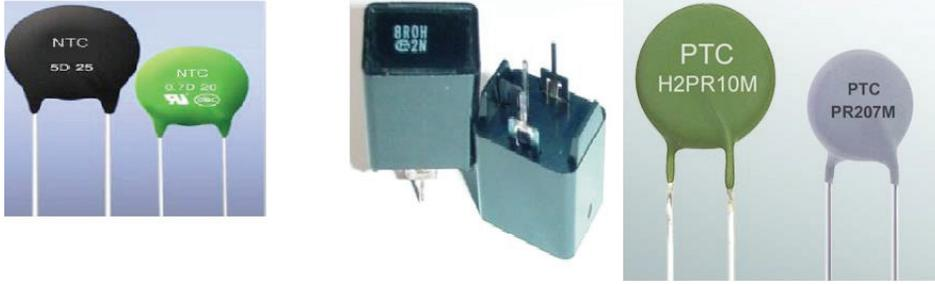
الشكل(11): مقاومات ذات معامل حراري موجب ومعامل حراري سالب
