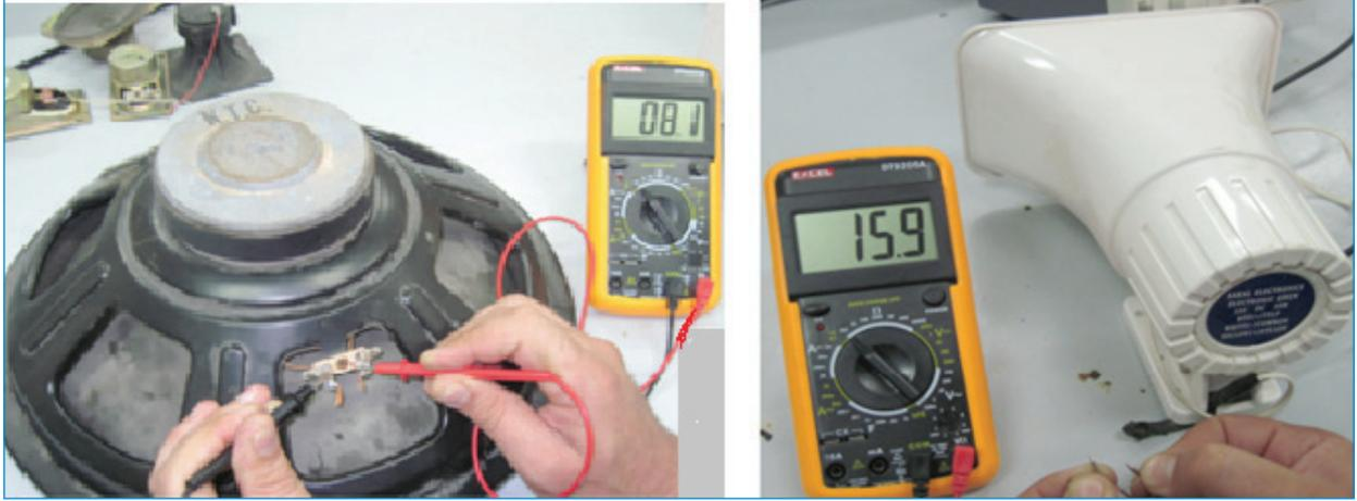
الشكل (16): قياس قيمة مقاومة السماعة
