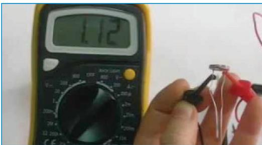
الشكل (11): طريقة فحص المقاومة الضوئية
