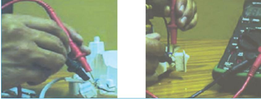
الشكل (13): فحص المفتاح عن طريق فحص الاستمرارية
