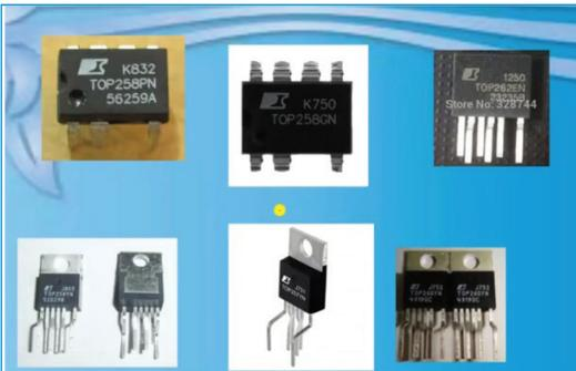
الشكل (13): بعض أنواع وأشكال (IC) التحكم المفتاحية
