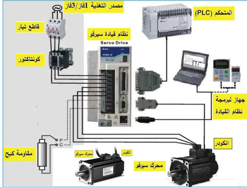
الشكل (2): العناصر الأساسية لنظام تشغيل سيرفو صناعي
