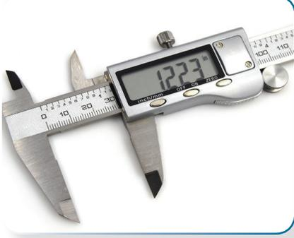
2 **الكليب (الورنية):** وهي أداة قياس تُستعمل لقياس البعد (السُمك) بين سطحين متوازيين، وقطر الأسطوانة التي يصل قطرها إلى ٤٠ سم تقريباً، كما تقيس أيضاً القطر الداخلي للأسطوانات، وعمق الثقوب، وهي دقيقة جداً، ويوجد منها البسيط، والإلكتروني. يسمح الكليب بدقة قياس ٠،٠١ مم، ويُستعمل كثيراً في الصناعات المعدنية، والخشبية.
