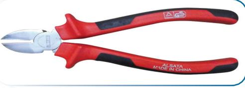
تُستخدم القطّاعة في عمليات قطع الأسلاك بالأطوال المرغوب فيها، كما أنها تُستخدم أيضاً في تقشير الأسلاك الكهربائية، حيث أنها تحتوي على فكّين ذوي حديّ قطع تُستخدمان في ذلك.
