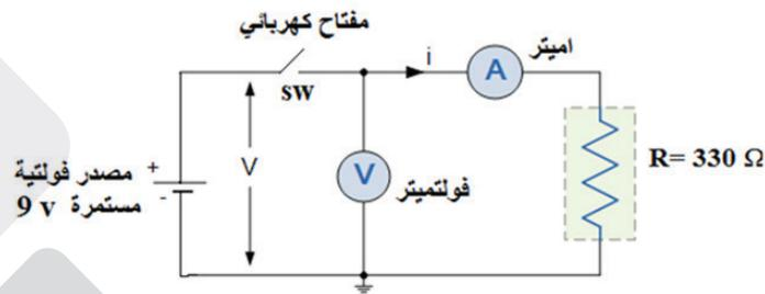
شكل (1): قياس الجهد والتيار في الدارة الكهربائيّة البسيطة
