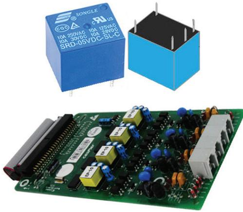
وصف الموقف التعليمي التدريسي: مقسم هاتفية داخلي خاص (سنترال) في إحدى المؤسسات، يتّصل به 4 خطوط خارجية. تحتوي الدارة الإلكترونية لكل خط على مرّحل (Relay) لتحسّس حالة رفع سماعة الهاتف، من أجل إجراء المكالمات الخارجية (شكل 1). تعطلت دارة أحد الخطوط، فطلب إليك فني الصيانة فحص المرّحل فيها، واستبداله في حال تبيّن أنه تالف.
