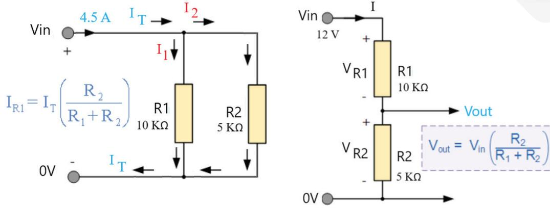
شكل (20): مبدأ توزيع الفولتيّة ومبدأ توزيع التيار
