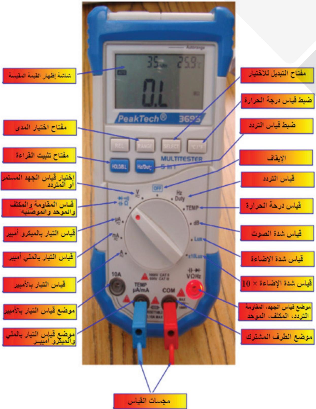
شكل (1): واجهة جهاز قياس متعدد الأغراض
