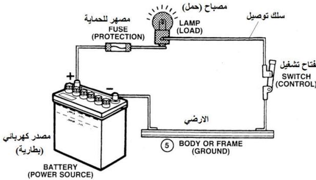
شكل (2): مكونات دارة كهربائية بسيطة
