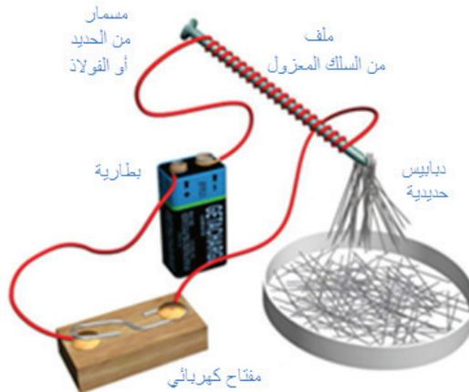
شكل (2): عمل مغناطيس كهربائي بسيط
