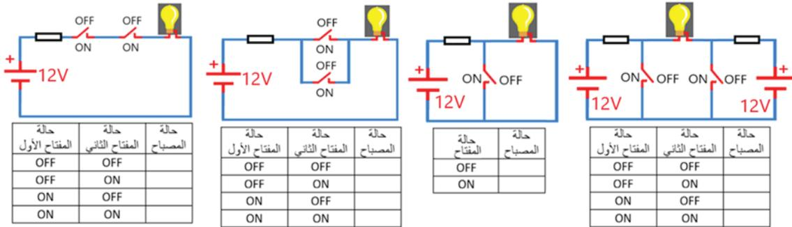
شكل (4): تمثيل عدد من البوابات المنطقية باستخدام المفاتيح الكهربائية
