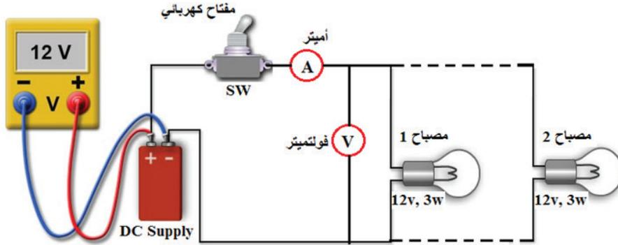
شكل (1): دارة قياس القدرة الكهربائيّة
