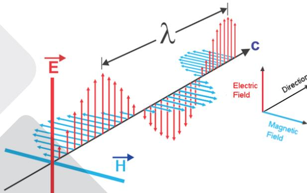
شكل (2): مكونات الموجة الكهرومغناطيسية (المركبة الكهربائية والمركبة المغناطيسية) واتجاه انتشار الموجة
