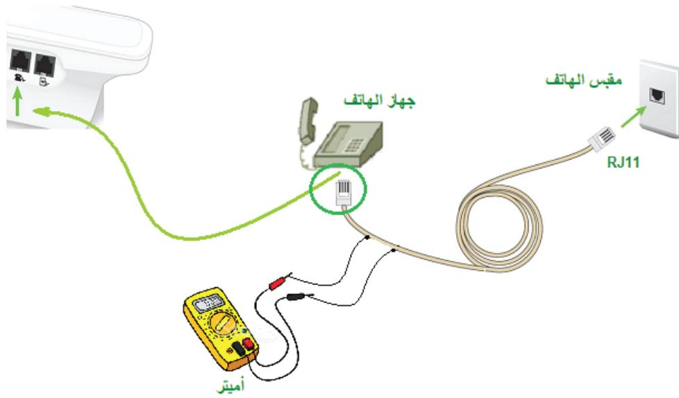
شكل (4 - ب) قياس تيار خط الهاتف في حالة OFF-Hook
