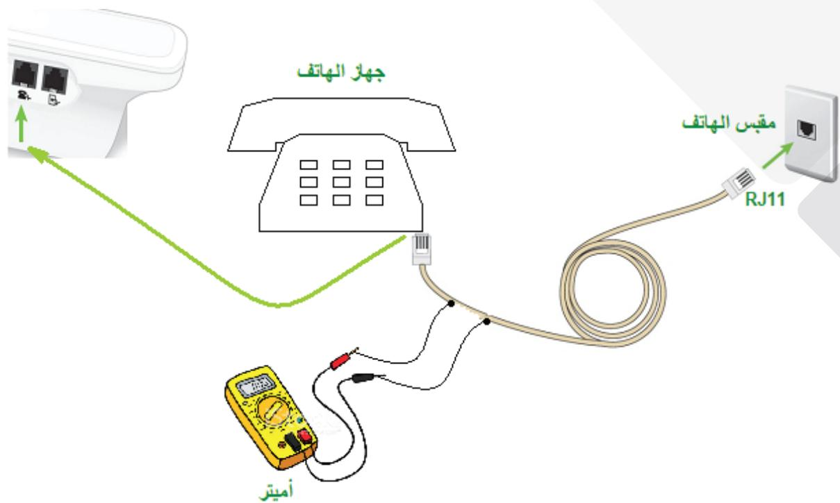
شكل (3 - ب) قياس تيار خط الهاتف في حالة ON-Hook
