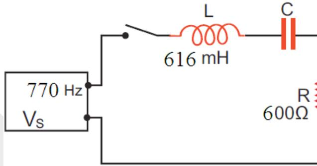
في لوحة المفاتيح في جهاز هاتف الكبسات يتم توليد نغمات ذات ترددات محدّدة لتمثيل الأرقام المختلفة في اللوحة، كلما تمّ الضغط على أحد تلك الأرقام عند إجراء الاتّصالات التلفونية. أحد الترددات الأساسيّة المستخدمة لهذا الهدف هو التردد 770Hz، ويتمّ استخدام دارة رنين توالٍ (لتعمل كمرشّح BPF) من أجل تمرير هذا التردد إلى الخط الهاتفي، (شكل 4).
