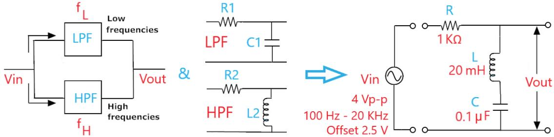
شكل (10): المخطط الصندوقي والدارة الكهربائية لمرشح (BSF).
