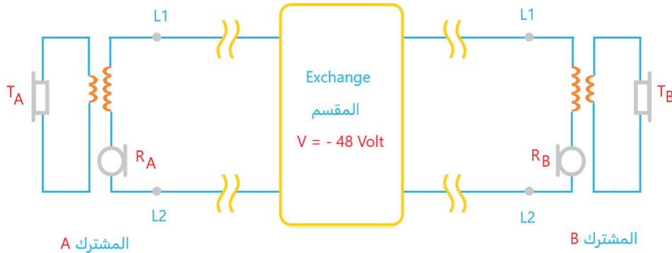
شكل (2): الدارة الكهربائية المغلقة بين جهاز المشترك والمقسم
