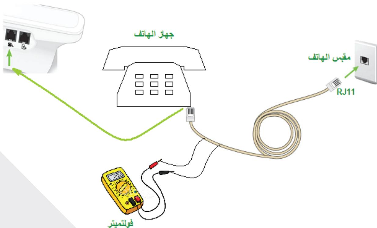
شكل (3 - أ) قياس فولتية خط الهاتف في حالة ON-Hook
