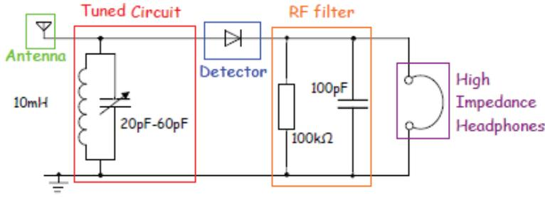
ويُبيّن (شكل 6) دارة ناخب القنوات لجهاز استقبال إذاعيّ بسيط يعمل ضمن ترددات (AM)، جد المدى الترددي للقنوات التي يستطيع هذا الجهاز استقبالها.
