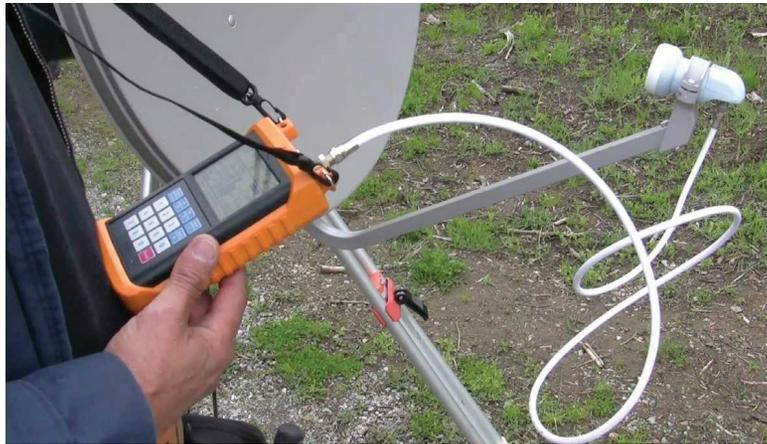
شكل (12): معايرة الهوائي الصحن واللاقط باستخدام جهاز ضبط الإشارة
