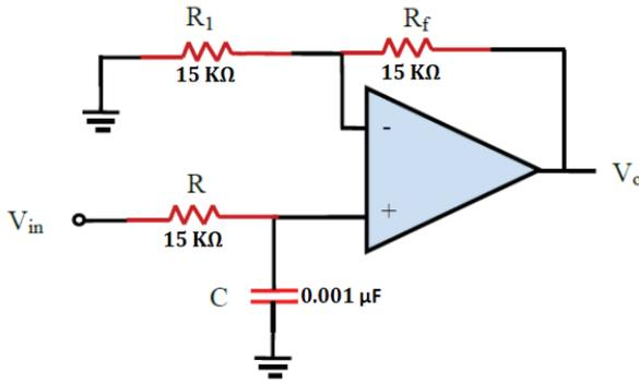
كسب المكبّر غير العاكس يساوي:  $A_v = \frac{R_f}{R_1} + 1$  تعمل كل من المقاومة (R) والمكثّف (C) على تحديد تردد القطع  $f_c$  الذي يبدأ عنده إيقاف تمرير الترددات غير المرغوب فيها. وبذلك يكون قد تمّ اختيار انتقائية المرشح وضبطها. أمّا المقاومتان ( $R_1$ ،  $R_f$ ) فيتم من خلالهما تحديد الكسب للمرشح الفعّال.
