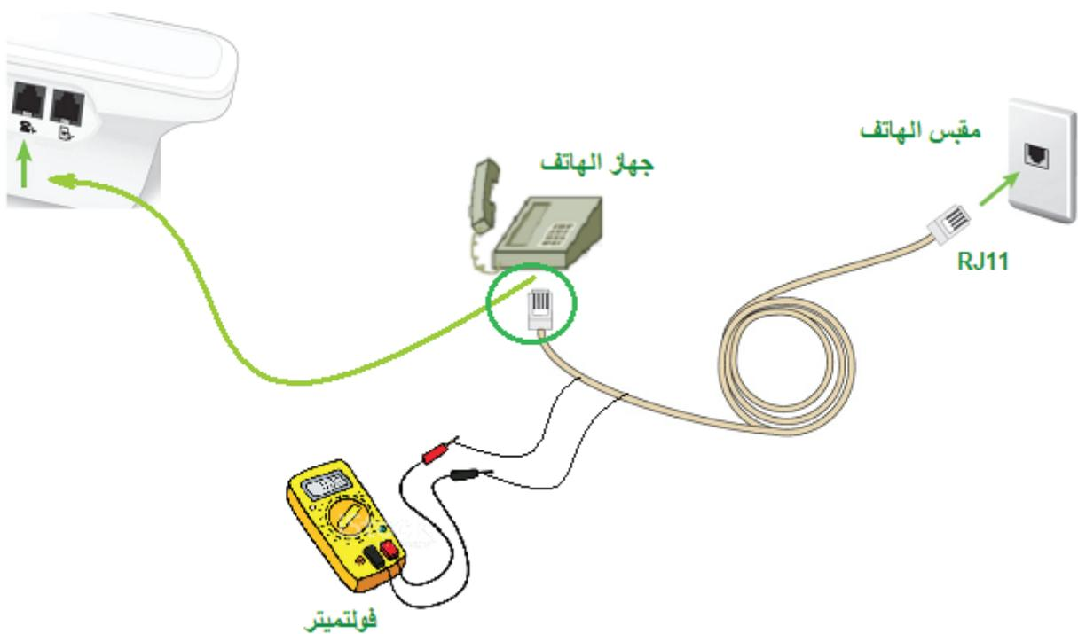
شكل (4 - أ) قياس فولتية خط الهاتف في حالة OFF-Hook
