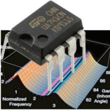
وصف الموقف التعليمي التعليمي: أحد الهواة أحضر إلى ورشة صيانة أجهزة الاتصالات جهاز إرسال (FM) مداه 1 كم، ولوحته الإلكترونية الداخلية كتلك المبينة في الشكل (1). تتم عملية التكبير السمعي الأولي للإشارة السمعية المراد إرسالها عبر الجهاز باستخدام رقاقة مكبّر العمليات 741 التي تعمل كمكبّر عاكس للإشارة. وقد تعطل عمل الجهاز بسبب تلف الرقاقة المذكورة.
