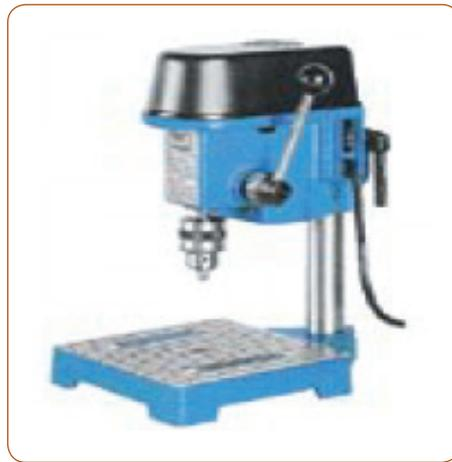
**2. المثاقب القائمة التي تُدار بواسطة التروس:** تُشابه المثاقب السابقة في تصميمها باستثناء أنها لا تُدار بواسطة سيور، وتُزداد فيها قدرة المحرك، ويضم رأس المثقاب صندوق سرعاتٍ خاصّة، وبذلك يُمكن تحقيق مدّى واسع من السرعات، وتتم حركة التغذية إمّا يدويّاً عن طريق الذراع أو آلياً بواسطة تروس التغذية ويبيّن الشكل مثقاباً قائماً يُدار عن طريق التروس.
