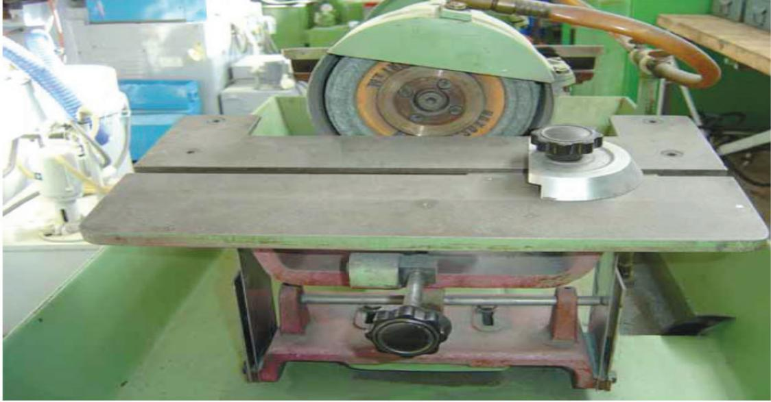
وبعد شحذ قلم الخراطة يتمّ التحقق من قياس الزوايا باستخدام محدد قياس شحذ أقلام الخراطة المبين في الشكل .
