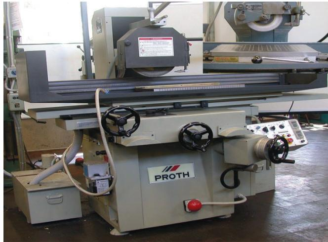
2 - **الطاولة المتذبذبة:** وهي طاولة قابلة للضبط، تتركز على صفيحتين من الفولاذ الزميركي المرن، تسمحان لها بحركة طولية متذبذبة عند دفعها باليد، ويحتوي السطح العلوي للطاولة على مجارٍ على شكل حرف T لتثبيت ملحقات التجليخ المختلفة، ويتم تثبيت أداة القطع على الطاولة بواسطة منقلة الربط بالاتجاه المناسب في مواجهة قرص التجليخ، كما يمكن إمالة سطح الطاولة كما في الطاولة القلابية. ويبيّن الشكل الطاولة المتذبذبة.
