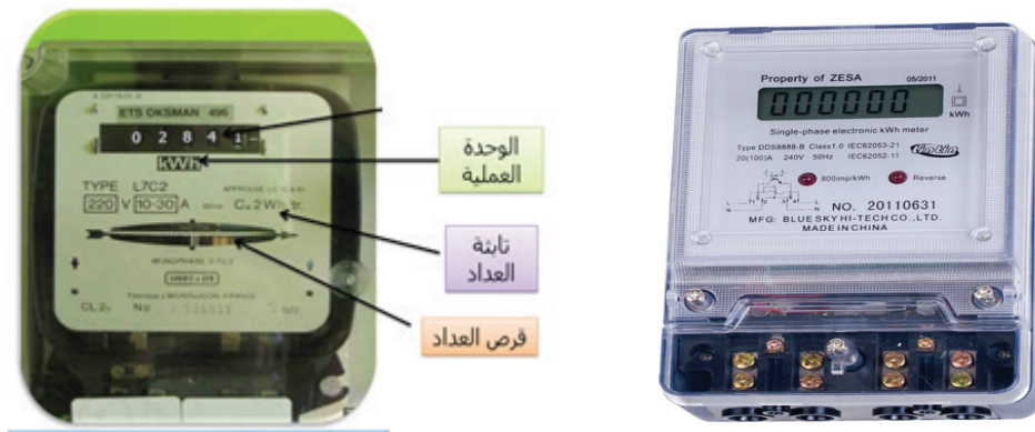
شكل (3): جهازا قياس الطاقة الكهربائية الحثي والإلكتروني
