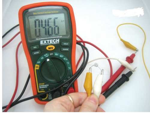
الشكل (4): فحص المقاومة الضوئية عند وجود ضوء ساقط عليها
