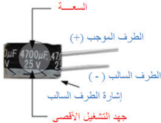
الشكل (7): قراءة السعة الكهربائية للمواسع
