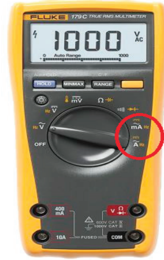
الشكل (3): ضبط وضعية قياس التيار
