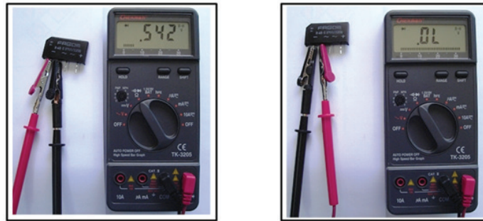
الشكل (7): فحص قنطرة التوحيد باستخدام جهاز الأفوميتر الرقمي
