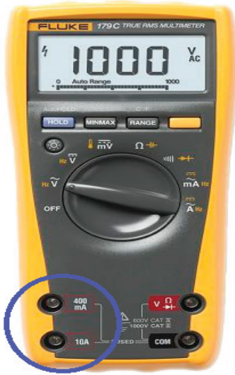
الشكل (4) توصيل اطراف جهاز الاميتر
