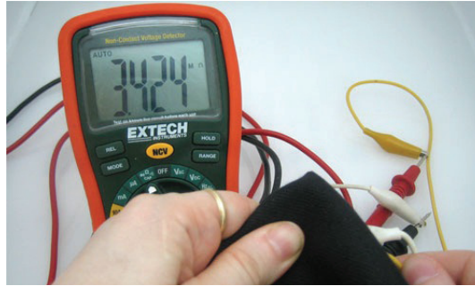
الشكل (5): فحص المقاومة الضوئية في الظلام
