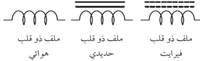
الشكل (2): ملفات ثابتة الحثية ذات قلوب مختلفة
