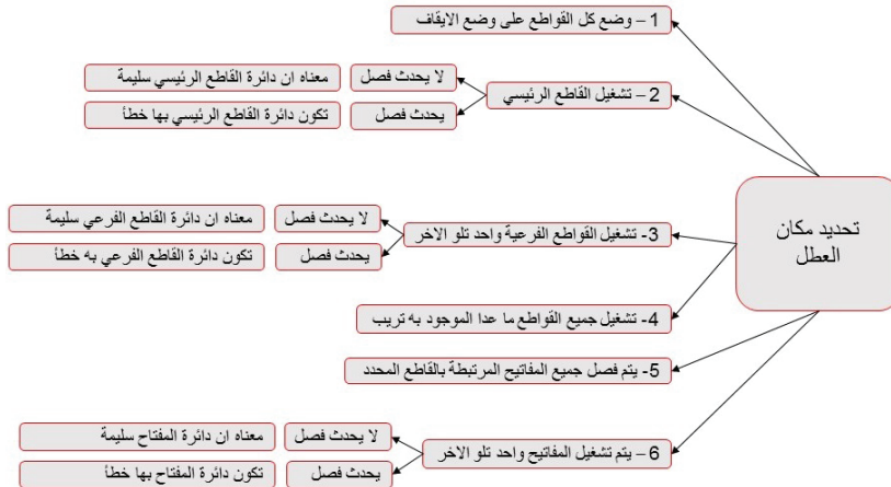
ويبين الشكل (4) الآتي طريقة تحديد مكان العطل في الدوائر الكهربائية المعطلة:
