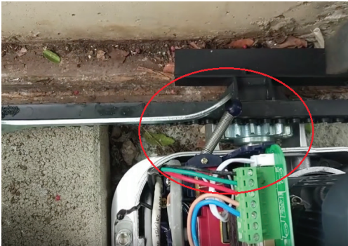
الشكل (8): تفعيل قطعة المعايرة حسّاس الفتح
