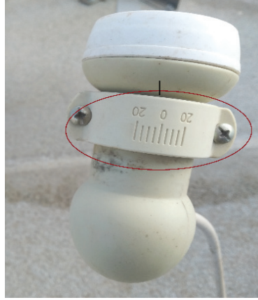
الشكل (7): ضبط زاوية قطبية اللاقط
