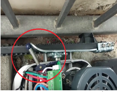
الشكل (9): تفعيل قطعة المعايرة حساس
