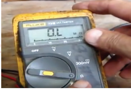
الشكل (8): ضبط جهاز الأفوميتر على تدرج الأوم
