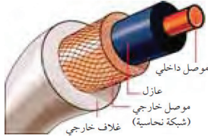
الشكل (1): التركيب الداخلي للكابل المحوري
