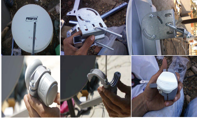
الشكل (12): تجميع أجزاء طبق الاستقبال
