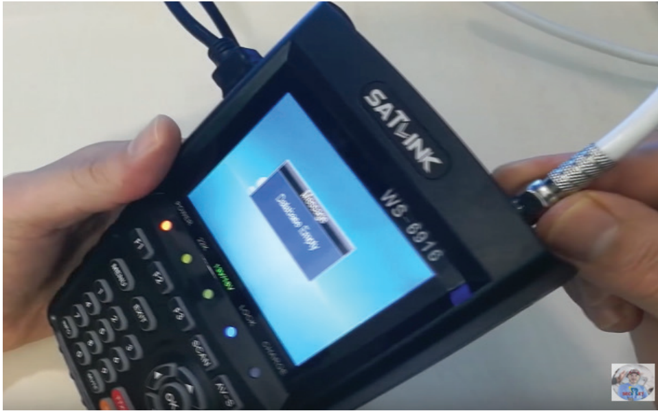
الشكل (14): ربط جهاز معايرة الستالايت باللاقط
