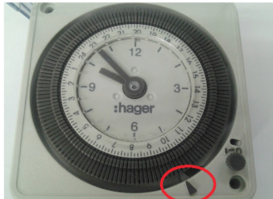
الشكل (٢): ضبط الساعة الحقيقية للمؤقت الزمني
