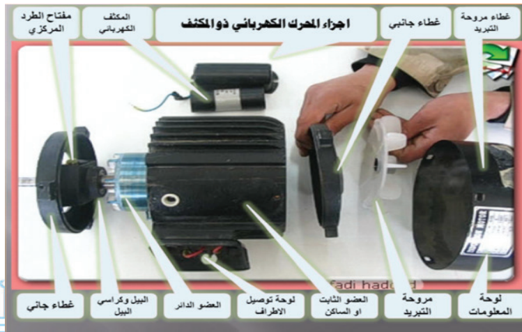
الشكل (1): أجزاء محرك تيار متردد أحادي الطور
