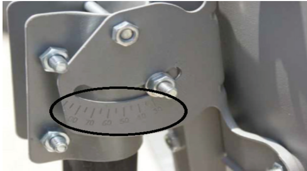
الشكل (5): ضبط زاوية الارتفاع للطبق
