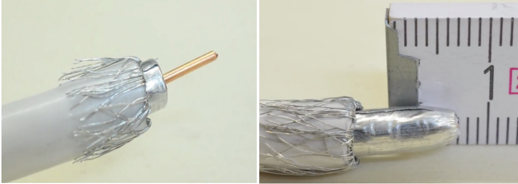
الشكل (5): تعرية طبقة العازل الداخلية للكابل
