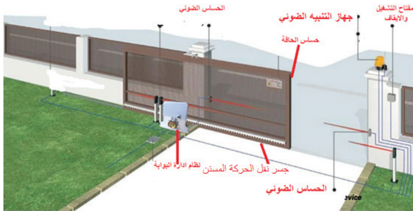
الشكل (1): مكونات نظام التحكم بالبوابة الكهربائية
