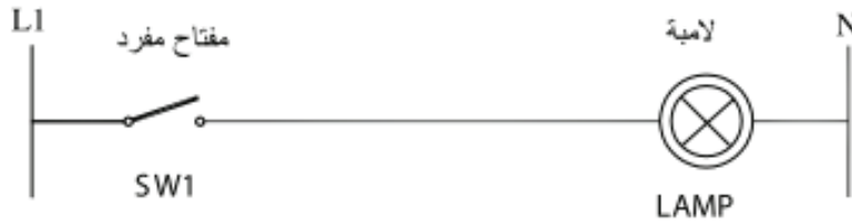
الشكل (1): مخطط مسار التيار لتوصيل مصباح مع مفتاح مفرد
