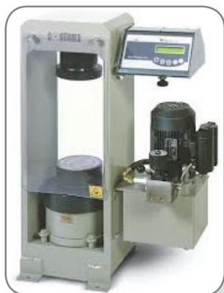
والشكل (22) جهاز فحص مقاومة الضغط للخرسانة.
