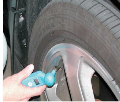
تفقد ضغط الهواء في الإطارات، والطريقة الصحيحة لعمل المداورة بين العجلات
