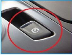
بعض المركبات التي تستخدم فرملة توقف كهربائية يمكن تفعيلها عندما تتوقف السيارة (على الإشارة الضوئية مثلاً) بشكل آلي، ثم تتحرر بمجرد الضغط على دواسة الوقود، وفي كلا النوعين السابقين يتم تفعيل فرامل التوقف عن طريق مفتاح كهربائي.
