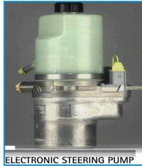
وظيفة هذه المضخة هي تحويل الطاقة الميكانيكية إلى طاقة هيدروليكية على شكل زيت متدفق تحت ضغط قوي لتوليد القوة المساعدة اللازمة، تتركب المضخة قريبة من المحرك ليتم تدويرها عن طريق قشاش المحرك أو يتم تدويرها بواسطة محرك كهربائي مستقل، كما في بعض المركبات، والأشكال الآتية تبين بعضاً منها.
