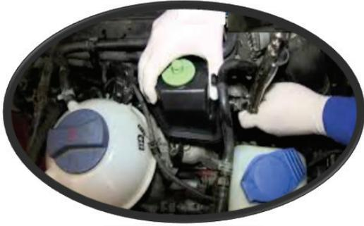
يغذي المضخة بالزيت اللازم لعملية التوجيه، ويركب على جسم المضخة أو منفصل عنها، ويُصنع من مادة ملائمة لا تتأثر بالزيت الهيدروليكي، وقد تحتوي على مقياس كمية الزيت لغرض التأكد من مستوى الزيت، ويجب ألا تقل الكمية عن الحد المسموح به، خوفاً من دخول الهواء إلى نظام التوجيه الهيدروليكي.
