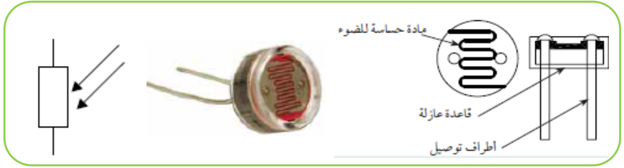
شكل (8): تركيب وشكل و رمز المقاومة الضوئية (LDR).
