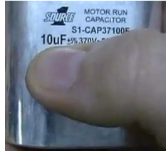
شكل (4): مواسع ورقي مشبع بالزيت.
