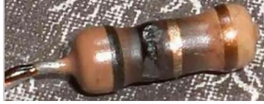
شكل (10): مقاومة كربونية تالفة نتيجة مرور تيار عال فيها
