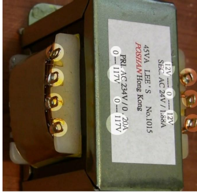
شكل (2): اللوحة الاسمية للمحول
