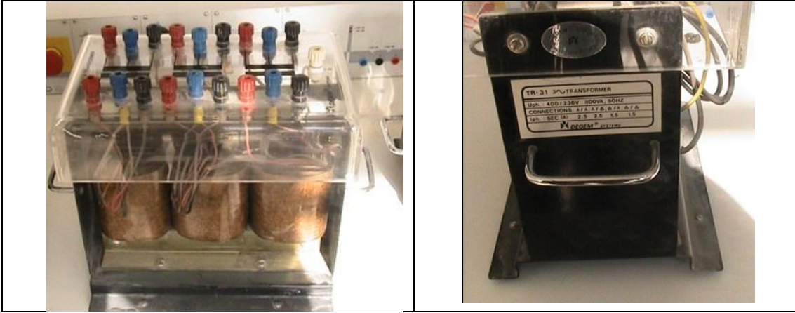
شكل(2):اختيار ثلاثة محولات منفصلة وقراءة اللوحة الاسمية لهم
