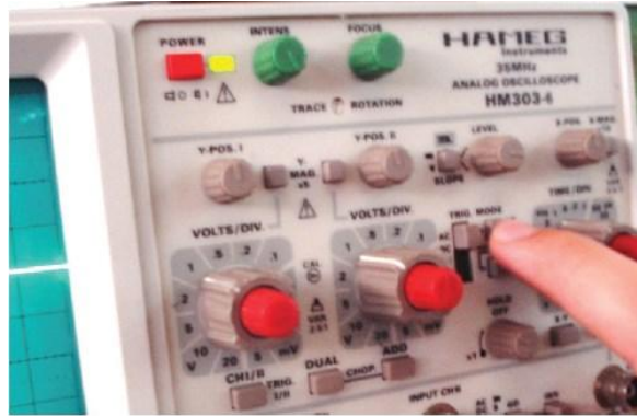
شكل (6): ضبط وضع مفتاح القذح
