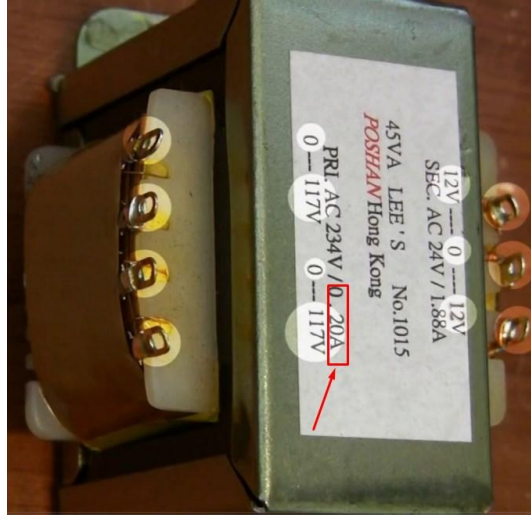
شكل (7): أقصى تيار للملف الابتدائي
