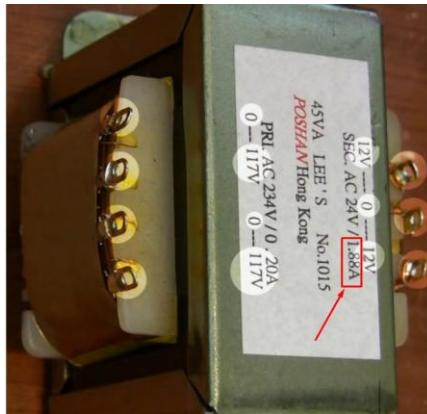
شكل (8): أقصى تيار للملف الثانوي
