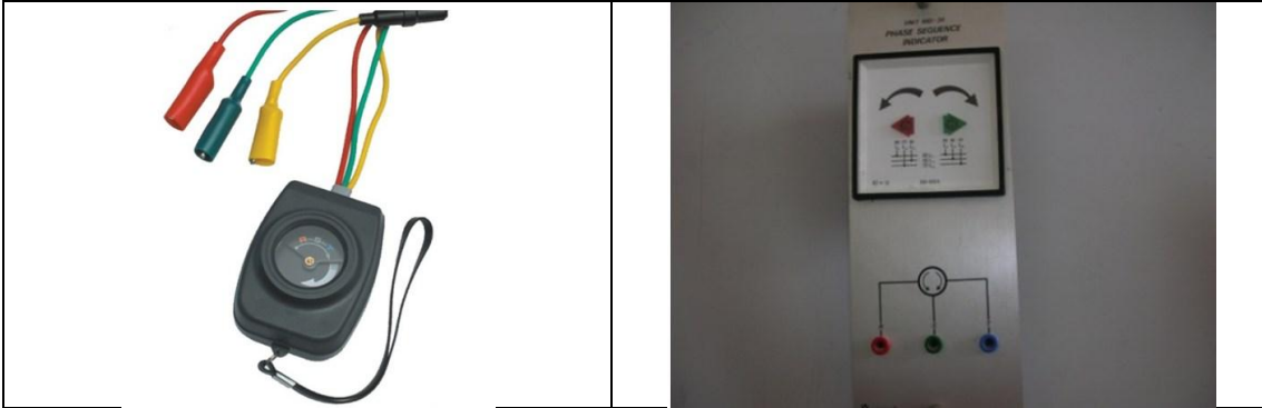
شكل (1):صورة لأجهزة تحديد ترتيب الاطوار الثلاث
