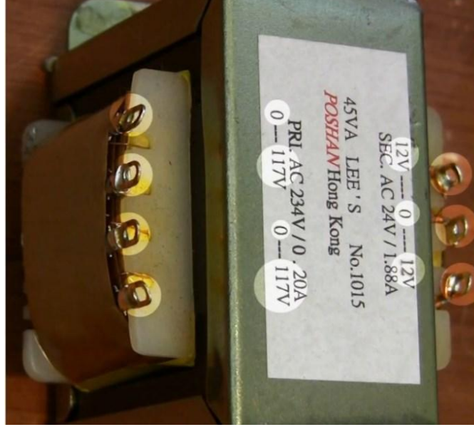
شكل (1): محول كهربائي
