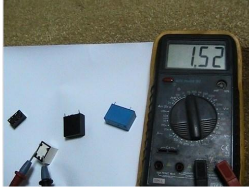
شكل (7): فحص ملف المرحل على إشارة المقاومة
