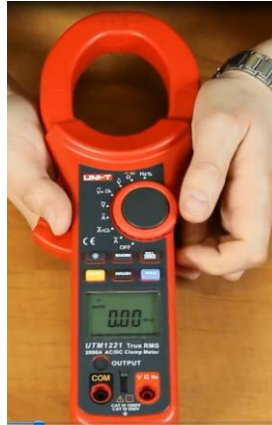
شكل (1):جهاز القياس متعدد الاغراض ذو الملقط (clamp meter)
