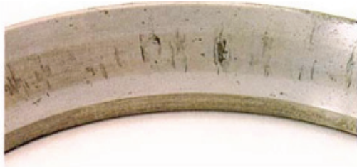
الحلقة الخارجية نتيجة التآكل بسبب الماء
