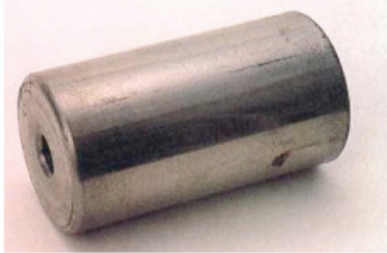
أسطوانة لبيلية أسطوانتي نتيجة عدم الخبرة عند تركيب البيلية
