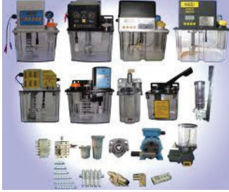
شكل (17): أجزاء دورة التزييت الأتوماتيكية
