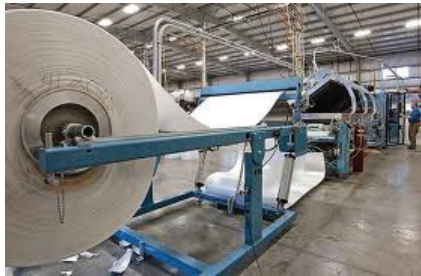
شكل (5): ماكينة لصنع الكاسات البلاستيكية
