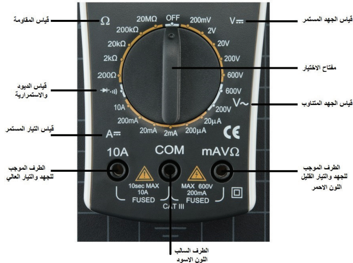
شكل (3): أجزاء ودلالات ورموز جهاز القياس (DMM)
