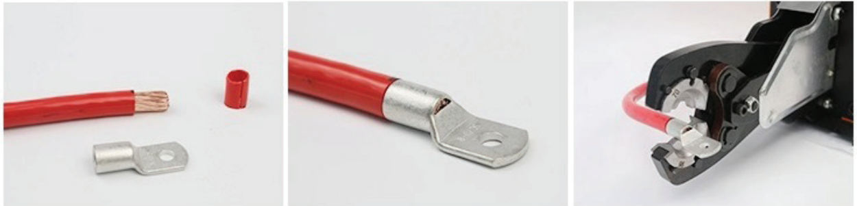
شكل (3): طريقة تركيب نعل كابل لأطراف كابلات ذات مقاسات كبيرة
