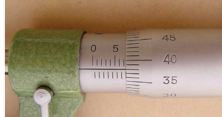
الشكل (32 - أ): قراءة الميكرومتر
