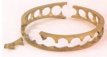
الحلقة القفصية للكرات نتيجة عدم التزييت
