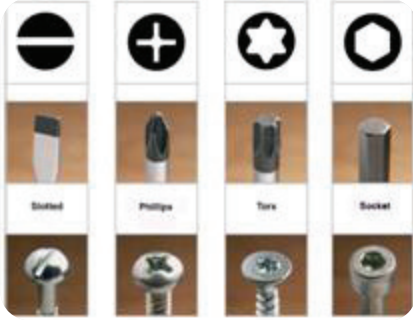
شكل (2): أنواع المفكّات حسب نوع رؤوسها
