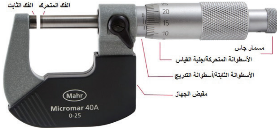
شكل (21): أجزاء الميكرومتر
