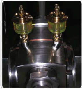
شكل (20): التزيت بالاهتزاز
