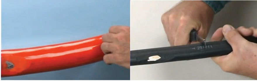
شكل (6): كابلات غالية الثمن ذات مساحة مقطع كبيرة تعرضت للعطب
