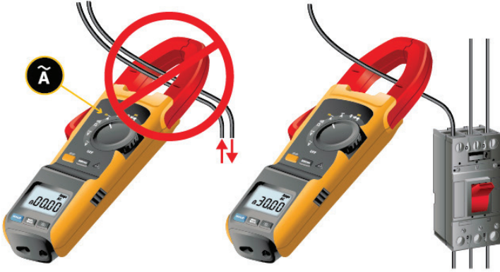
شكل (6): جهاز قياسي متعدد ذا ملقط (clamp Meter)
