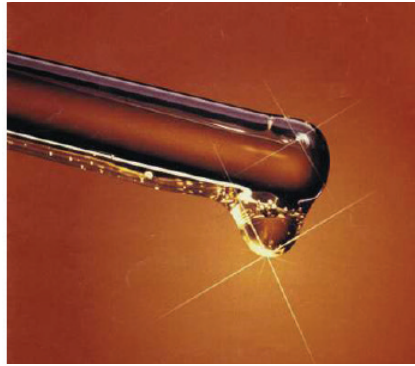
شكل (8) : اللزوجة مقاومة السائل للتدفق
