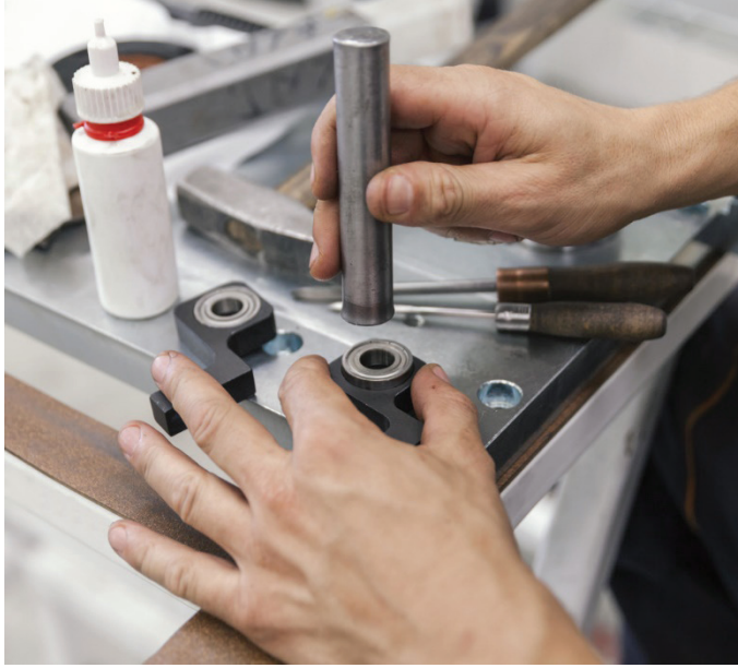
شكل (3): تركيب البيبل بواسطة جلبة التركيب
