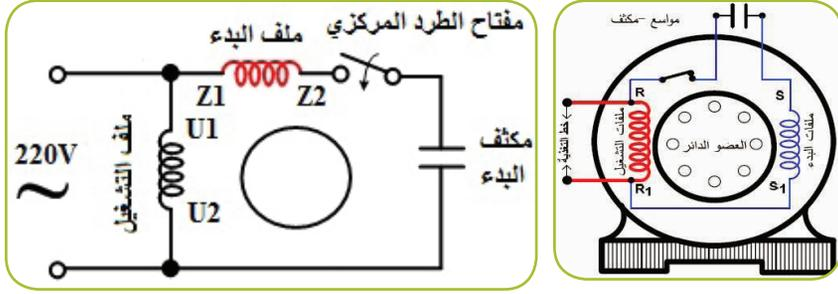
شكل (10): الدائرة الكهربائية والمخطط التمثيلي للمحرك ذي مكثف البدء
