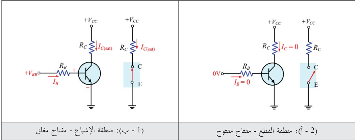
شكل (2): دائرة المفتاح الترانزستوريّ والدائرة المكافئة للمفتاح الترانزستوريّ باستخدام المفاتيح
