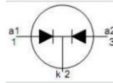
شكل (26): ديود شوتكي يتحمل تيار حتى (15A) ورمزه الكهربائي
