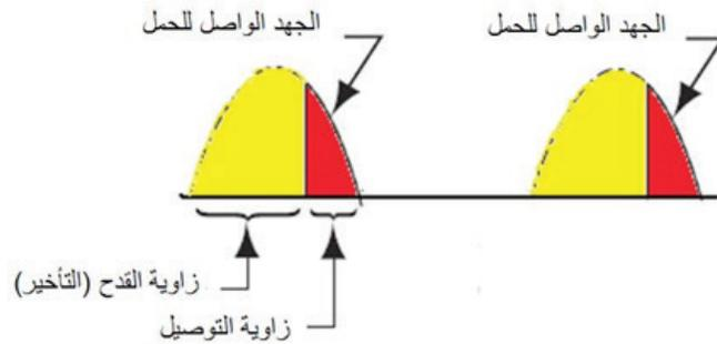
شكل (11): التحكم بالقدرة بواسطة التحكم بزوايا القدح (نصف موجة محكومة)
