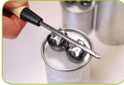
شكل (14): قصر طرفي المكثّف لتفريغ الشحنة الكهربائيّة المخزنة به
