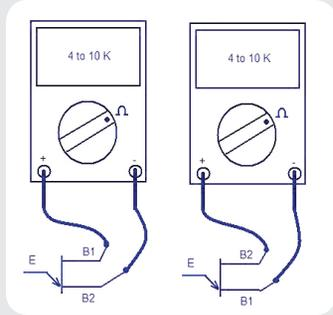
شكل (13): قياس المقاومة بين قياس المقاومة بين (B2/B1)
