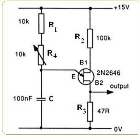
شكل (11): الترانزستور آحادي الوصلة كمذبذب تراخي
