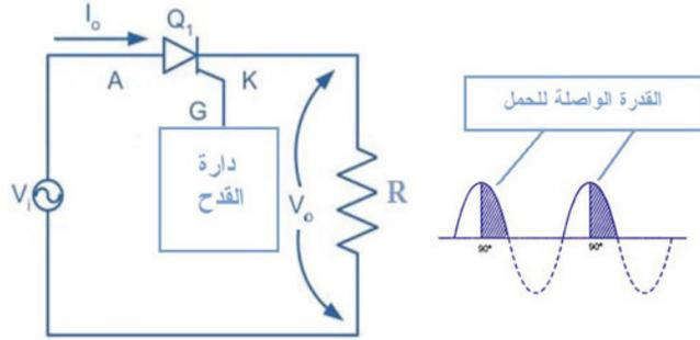
شكل (13): التحكم بالقدرة بواسطة الثايرستور
