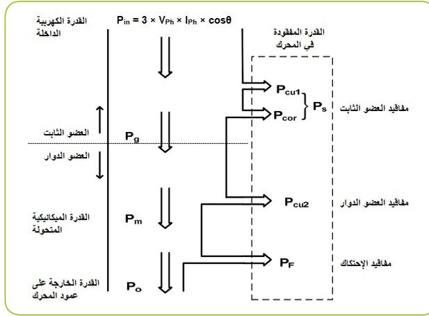
شكل (12): مخطط انتقال القدرة داخل المحرك الحثي
