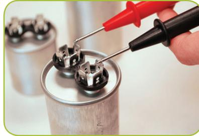
شكل (15): مس طرفي المكثّف بنهايتي جهاز قياس المقاومة التناظري
