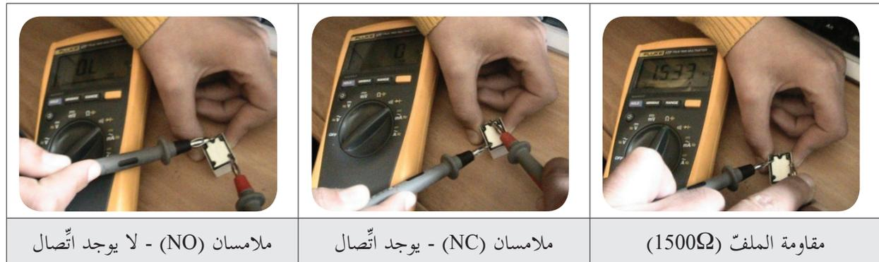
شكل (10): قياس مقاومة الملفّ - اتّصال النقطتين (C) و (NC) - لا اتّصال بين النقطتين (C) و (NO)
