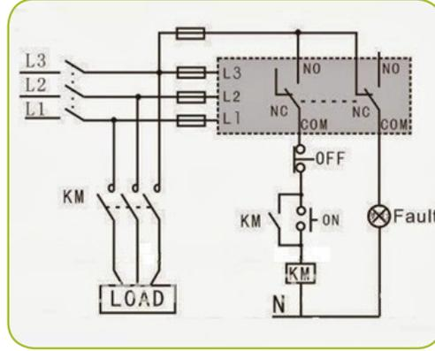
شكل (28): توصيل جهاز Phase Sequence
