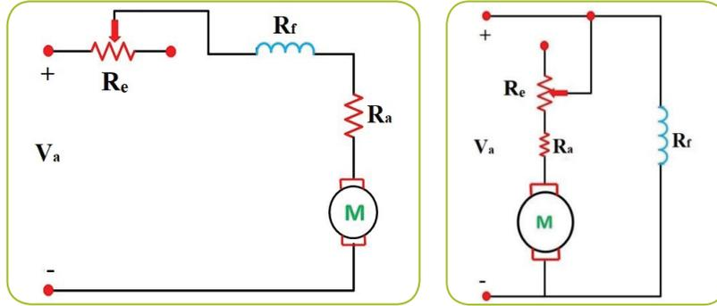
شكل (21): التحكم في سرعة محركات التيار المستمر عن طريق تغيير مقاومة المنتج
