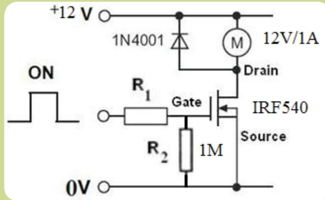
شكل (19): دائرة تشغيل المحرك بواسطة ترانزستور نوع موسفت (MOSFET)
