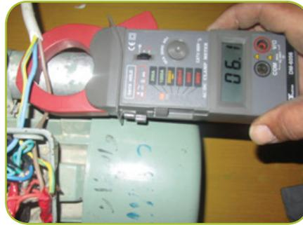
شكل (19): قياس تيار المحرك
