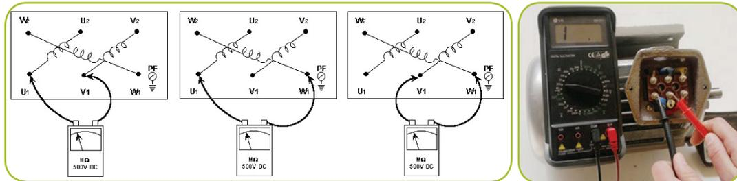
شكل (3): اختبار عزل ملفّات كلّ فاز عن الفاز الآخر
