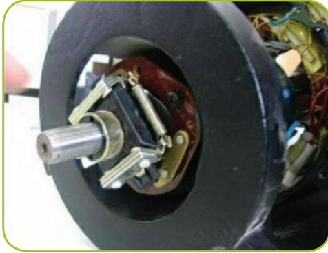
شكل (3): شكل الجزء الميكانيكي لمفتاح الطرد المركزي في المحركات الأحادية الطور
