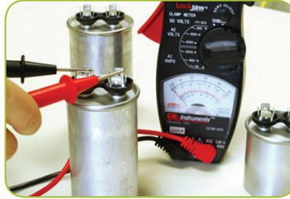
شكل (16): فحص المكثف باستخدام جهاز قياس تناظري Analog Meter
