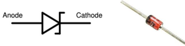
شكل (21): شكل ديود الزينر ورمزه الكهربائيّ
