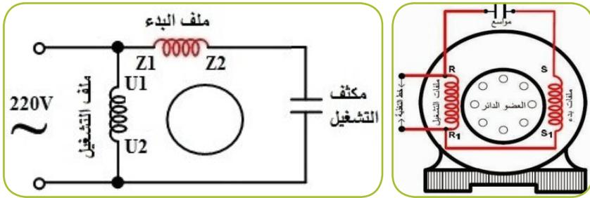
شكل (11): الدائرة الكهربائية والمخطط التمثيلي للمحرك ذي المكثف الدائم
