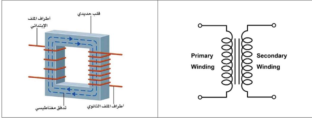
شكل (2): تركيب المحوّل الكهربائيّ ورمزه
