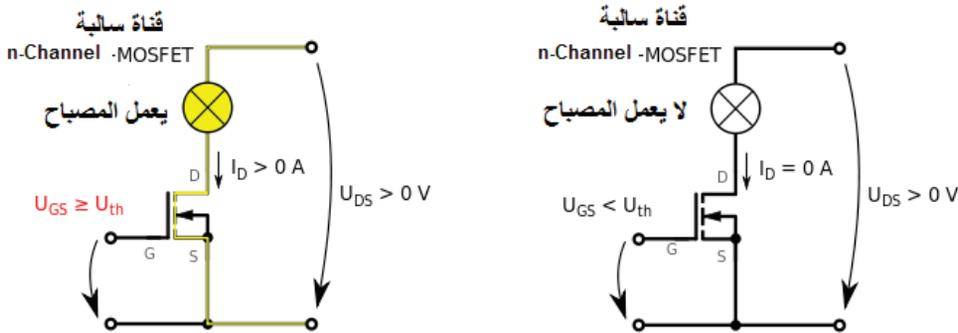
شكل (18): ترانزستور (MOSFET) لتشغيل مصباح في حالة (OFF/ ON)
