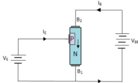
شكل (9): توصيل الترانزستور آحادي الوصلة
