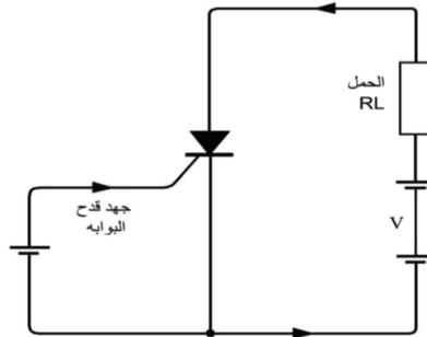
شكل (4): طريقة توصيل الثايرستور
