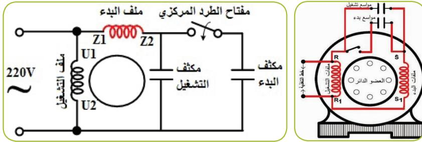
شكل (12): الدائرة الكهربائيّة والمخطط التمثيلي للمحرّك ذي المكثّفين
