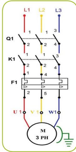
شكل (26): حماية المحرك بتركيب القاطع الحراري المغناطيسي
