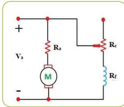
شكل (24): التحكم في سرعة محرّكات التّيار المستمرّ من نوع توازي عن طريق توصيل مقاومة متغيّرة ( $R_c$ ) على التوالي مع ملفات المجال
