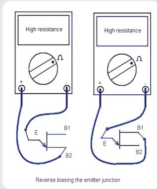
شكل (14): قياس المقاومة بين (E/B1) و (E/B2)
