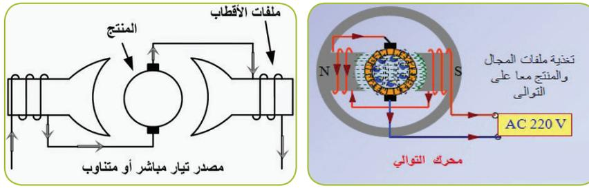
شكل (24): توصيل الجهد الكهربائي للمحرك العام
