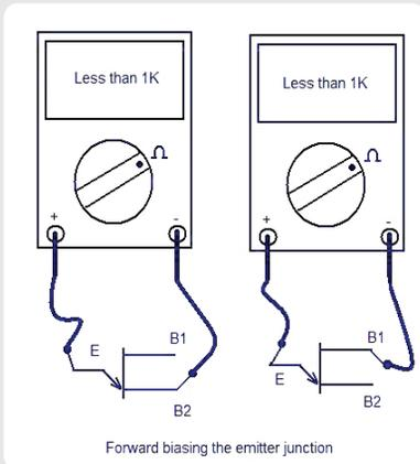
شكل (15): قياس المقاومة بين (E/B1) و (E/B2)
