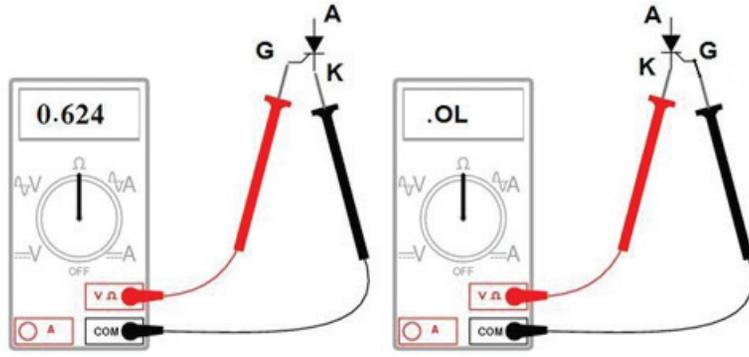
شكل (9): فحص الثايرستورات الحساسة ذات التيار القليل
