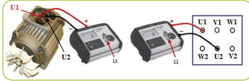
شكل (5): قياس استمرارية التوصيل في المحرك الكهربائي باستخدام جهاز الميجر
