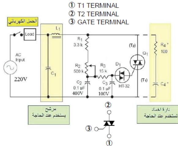
شكل (14): دائرة التحكم بالقدرة الواصلة للأحمال الكهربائية باستخدام الترياك
