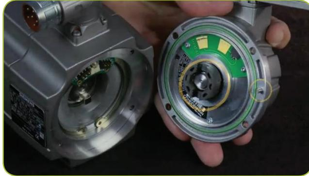
شكل (34): جهاز التغذية الراجعة لمحرك السيرفو (Encoder)
