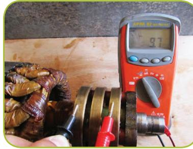
شكل (9): فحص الاتّصال الكهربائي بين حلقات الانزلاق
