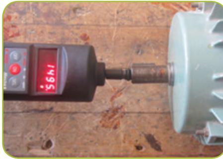
شكل (18): قياس سرعة المحرك الكهربائيّ
