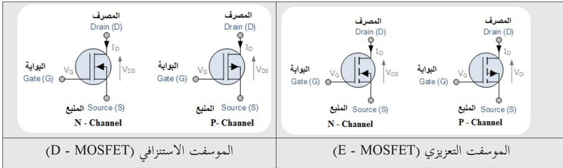
شكل (17): رمز أنواع الترانزستور (MOSFET)
