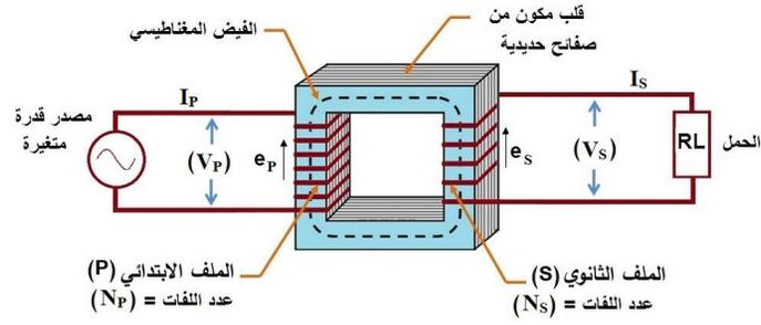
شكل (2): تركيب المحوّل الكهربائيّ والحثّ المتبادل
