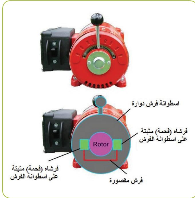
شكل (31): طريقة التحكم بسرعة المحرك التنافري واتجاهه
