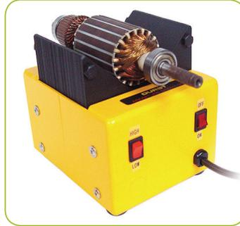
شكل (1): جهاز الزوام الكهربائيّ
