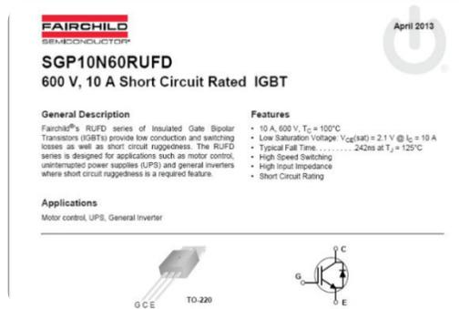
شكل (26): مقطع من نشرة البيانات الخاصّة بترانزستور (IGBT) نوع SGP10N60RUFD
