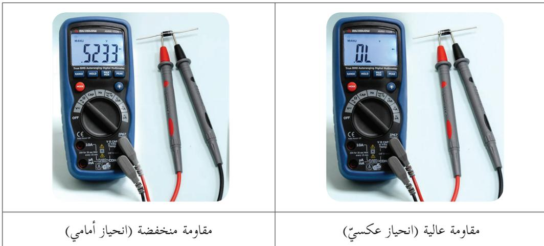
شكل (5): فحص صلاحية الديود باستخدام جهاز (DMM)
