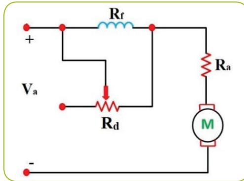
شكل (22): التحكم في سرعة محركات التيار المستمر من نوع توالٍ عن طريق مقاومة مجزأة للمجال
