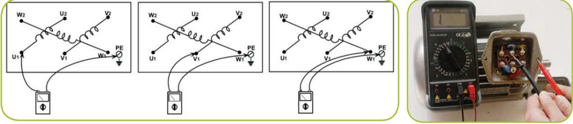
شكل (4): اختبار عزل كلّ فاز مع جسم المحرك
