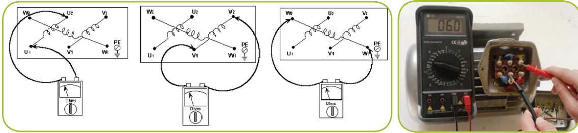
شكل (2): اختبار توصيل ملفّات كلّ فاز على حدة
