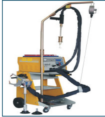
الشكل (2): النتاشة الكهربائية
