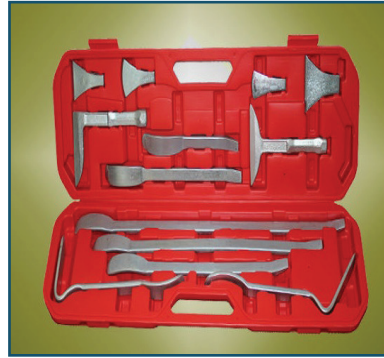
الشكل (6): عتلات التجليس، وملاعقها
