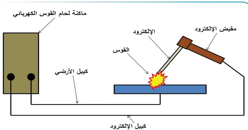
مخطط يبين لحام القوس الكهربائي (الإلكترود المغطّي)
