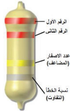
أ- الترميز اللوني الرباعي: تحدّد الحلقة الأولى من جهة اليسار الرقم الأول للمقاومة، وتحدّد الحلقة الثانية الرقم الثاني للمقاومة، وتحدّد الحلقة الثالثة المضاعف العشريّ (عدد الأصفار)، أما الحلقة الرابعة فتحدّد نسبة التفاوت المسموح به في قيمة المقاومة النظرية. كما يبين الشكل (9).
