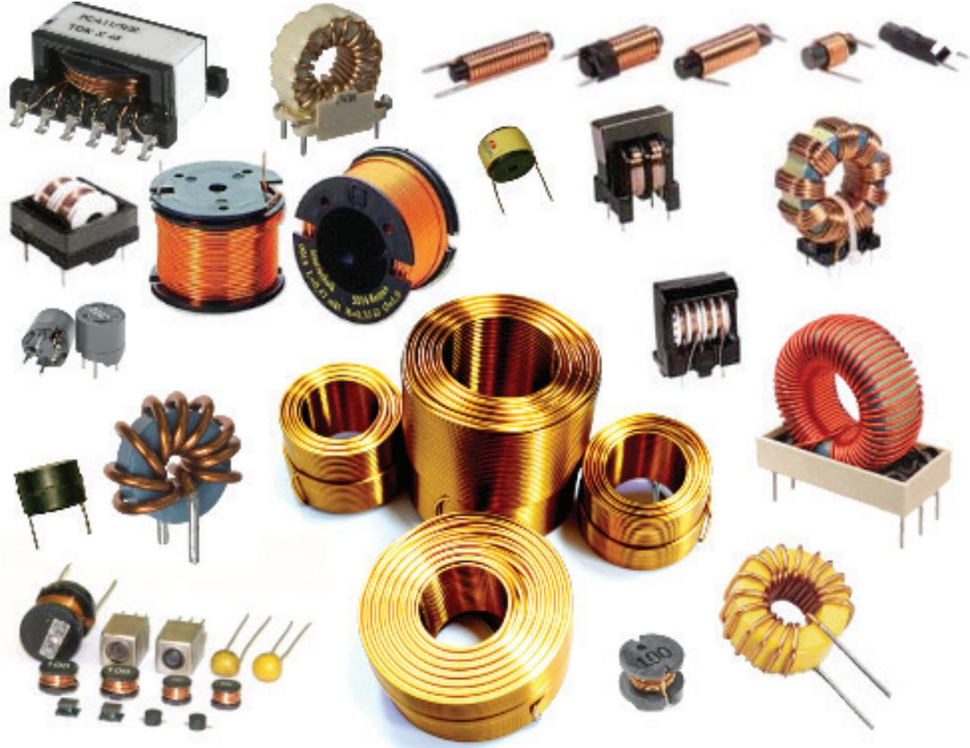
من بين أهمّ العناصر في مجال الإلكترونيات العمليّة هي الملفّات الكهربائيّة، لمميّزاتها ودورها الهامّ في الدوائر الكهربائيّة. والملفّ ببساطة هو سلك ملفوف حلزونيّاً، ذو عدد لفّات كبير، بحيث تشكّل شكلاً أسطوانيّاً. يُستخدم في الفيزياء، وفي الهندسة الكهربائيّة، ويكون عادةً ملفوفاً حول قلب هوائيّ، أو حديديّ، أو الفييريت.
