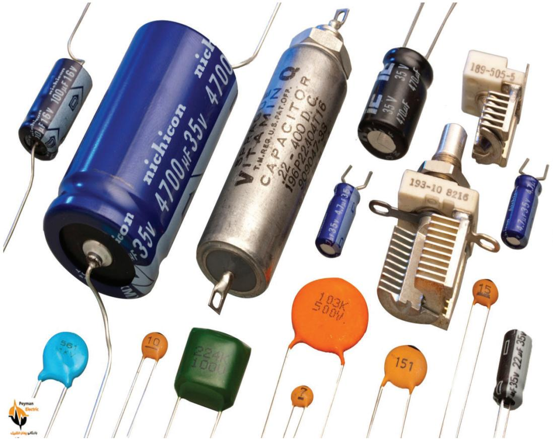
**المكثف الكهربائي:** عنصر لديه القدرة على تخزين الطاقة الكهربائية، ويتكوّن المكثّف من موصلين، يُعرّف كلّ منهما باللوّح المعدنيّ، ويوجد بينهما وسط عازل، وتُستخدَم موادّ عازلة، منها: الهواء، والورق المشرّب، وموادّ من البلاستيك، والميكا، وموادّ من السيراميك، كما يبين الشكل (1).
