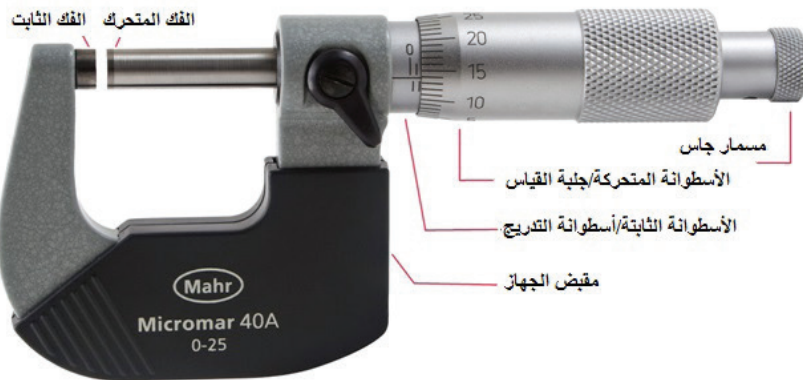
الشكل (24): أجزاء الميكرومتر
