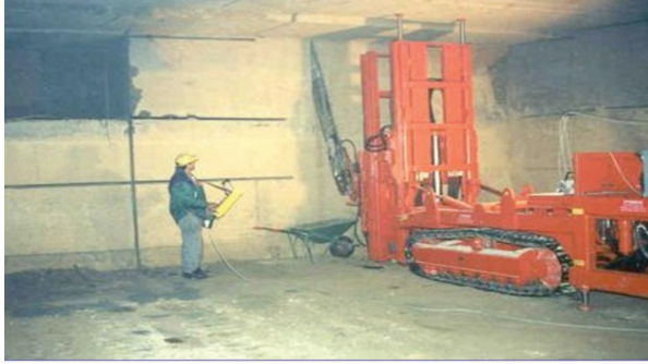
Chain-saw on mobile unit for underground quarry منشار سلسلة محمل على وحدة متحركة للتحجير تحت سطح الأرض
