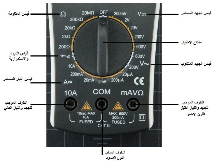
الشكل (3): أجزاء جهاز القياس (DMM)، ودلالاته، ورموزه
