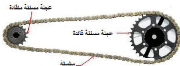
الشكل (9): أجزاء وسيلة نقل الحركة بالجننازير
