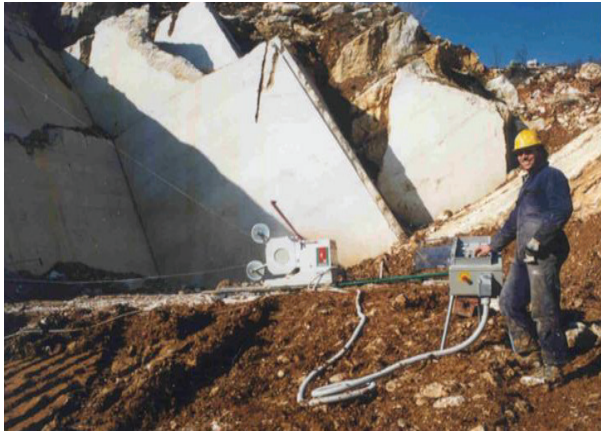
ماكينة سلك الماس: جسم الماكينة الرئيسي + لوحة التحكم الكهربائية
