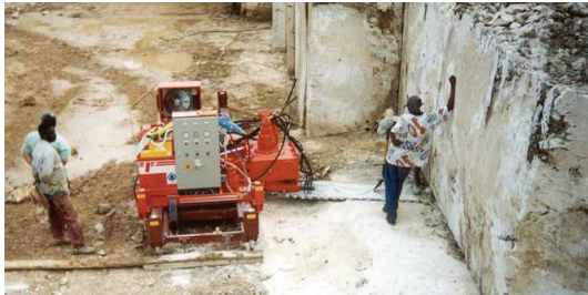
Chain-saw on mobile unit for underground quarry منشار سلسلة محمل على وحدة متحركة للتحجير تحت سطح الأرض
