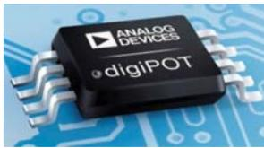
تعد الحساسية Sensitivity من الخصائص الأساسية للمقاومة الرقمية المتغيرة، والتي يتم التعامل معها بالنظام الثنائي، وتُمثّل هذه الحساسية بـ 8 bit، أي تعطي 256 قيمة مختلفة للمقاومة المتغيرة (0-255)، وتُستخدم مع المتحكم الدقيق Microcontroller، وفي دارات الصّوت الرقمية، وفي تطبيقات يصعب استخدام المقاومة المتغيرة التماثلية فيها.
