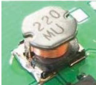
تشبه الملفات السطحية الملفات التقليدية في التركيب وتختلف عنها في الحجم، حيث تتكوّن من سلك بطول ومساحة مقطع محددة، لتحديد قيمة التيار الذي يمر في الملف.
