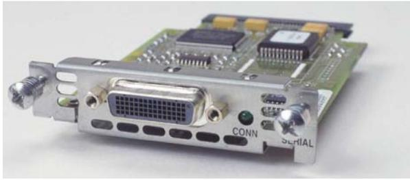
ويمكن إزالة هذه البطاقات في حال التلف أو الانتقال إلى تقنيات أحدث. الشكل المجاور يبين بطاقة تستخدم لإضافة منفذ اتصال بعيد، وهذه البطاقة تسمى (WAN Interface Card) أو اختصاراً (WIC)، وتختلف البطاقات حسب عدد المداخل والتقنية المستخدمة.
