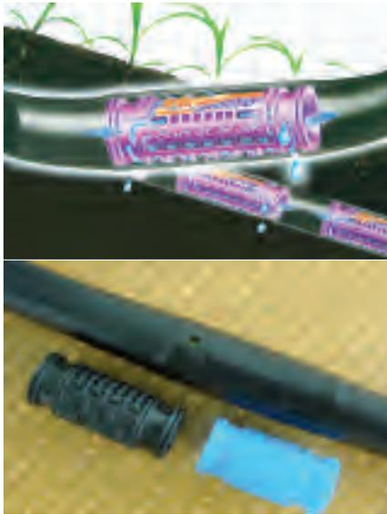
يعتمد مبدأ عمل النقاطات في الري بالتنقيط بالأساس على تشتيت الضغط الموجود داخل أنبوب الري، بحيث تخرج المياه على شكل نقاط، وبمعدل ثابت ودون ضغط قد يؤدي الى حفر التربة. وتحتوي النقاطة على ممر طويل تجري فيه المياه وتفقد الضغط بسبب الاحتكاك بجدار الممر، ومن ثم تخرج من فتحة النقاطة التي تظهر لنا، فيما تكون باقي الأجزاء مخفية داخل الأنبوب.
