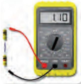
الشكل (٤) قياس المقاومة بجهاز المالتيميتر
