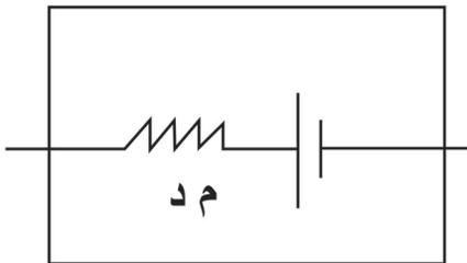
الشكل (٦) المقاومة الداخلية للعمود الكهربائي م د
