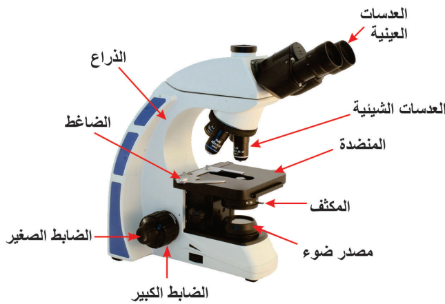
شكل (١٥): أجزاء المجهر المركب
